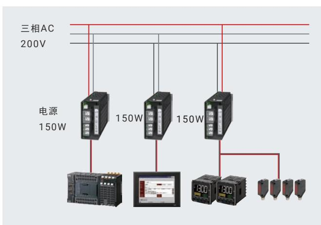
需要考量每个分支电源的负载容量平衡和设备保护，进行分散配置
