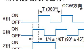
(动作图的ON、OFF表示输出晶体管的)
