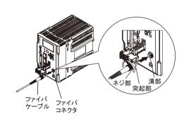
全な状態では、光信号の伝達が行えず、正しい測定ができません。 必ず「○」の状態になっていることを確認してください。
