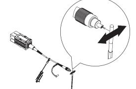
・クリーナの使用回数は1回です。再利用すると端面にゴミや傷がつき、 誤動作や測定誤差の原因となります。使用後は廃棄してください。 ・ファイバクリーナは必ずクリーニング部の布(白い端面)で清掃してく
