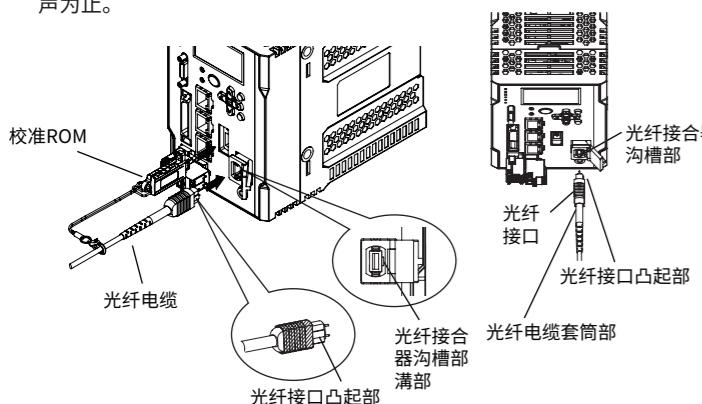
手持右图所示的光纤电缆套筒部(黑色部), 使光纤接合器沟槽部与光纤接口凸起部相互吻合, 然后插入至听到咔嚓声为止。
