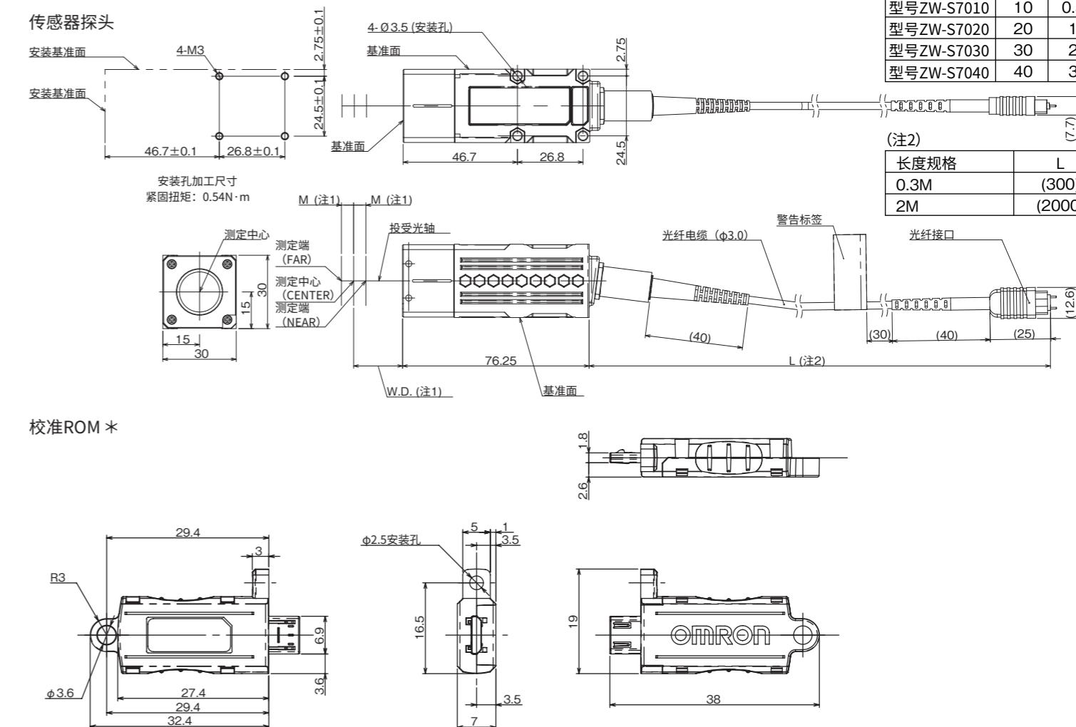
\*传感器探头(型号 ZW-S7010/S7020/S7030/S7040)的同箱产品。请务必使用相同序列号的传感器探头和校准 ROM 搭配使用。
