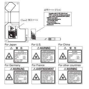
形ZS-HLDS14AF/TはGB7247.1:2012(IEC60825-1:2007)規格に定める Class2に分類されます。中国で使用する際は、警告ラベルを付属品の中文ラベルに 貼替えてください。
