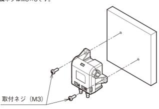
圧力導入口にエアチューブを差し込んでください。圧力導入口の上部に高 圧側 (▼Hi)、低圧側 (▼Lo) の刻印があります、測定対象に応じて適切 に接続してください。高圧側の圧力が高いと計測値は正値、低圧側の圧力 が高いと計測値は負値になります。
