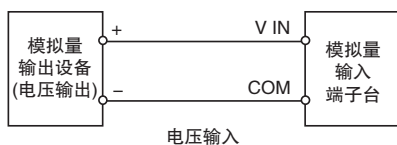
模拟量输入配线图
