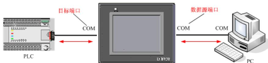
在连接的时候需正确设置数据源端口和目标端口参数。数据源端口指与 PC 连接的 HMI 一侧的串口；数据目标端口指与 PLC 连接的 HMI 一侧的串口。
