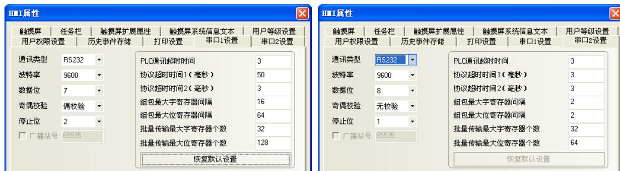
NB 主体有两个串口，所以在这里有两个[串口设置]，通过这两个串口，您可以连接到两个 PLC 上面。这两个串口的设置是完全一样，所以我们在这里只介绍一个串口。
