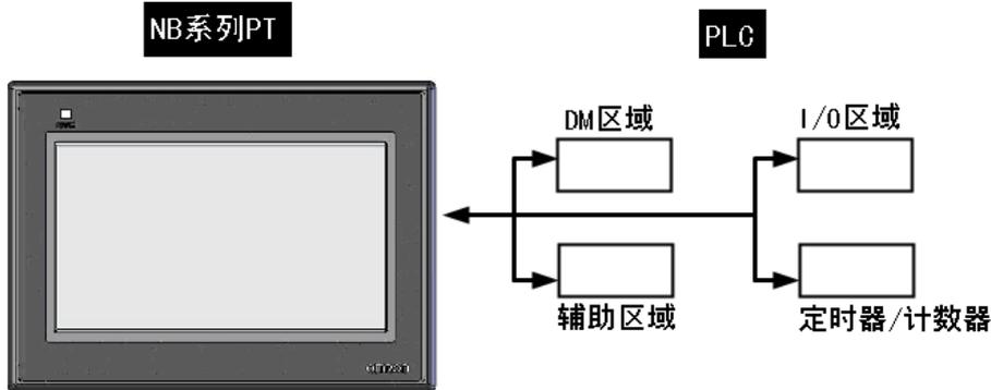
使用 NB 系列 PT 时，可采用 Host Link 方式与 PLC 连接。
