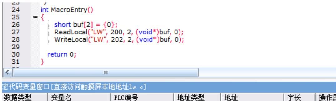
上面这段代码，就是一段可以使用的宏代码，其中没有定义一个变量，但是满足直接访问触摸屏的本地地址的格式，即 Read/Write Local address function:
