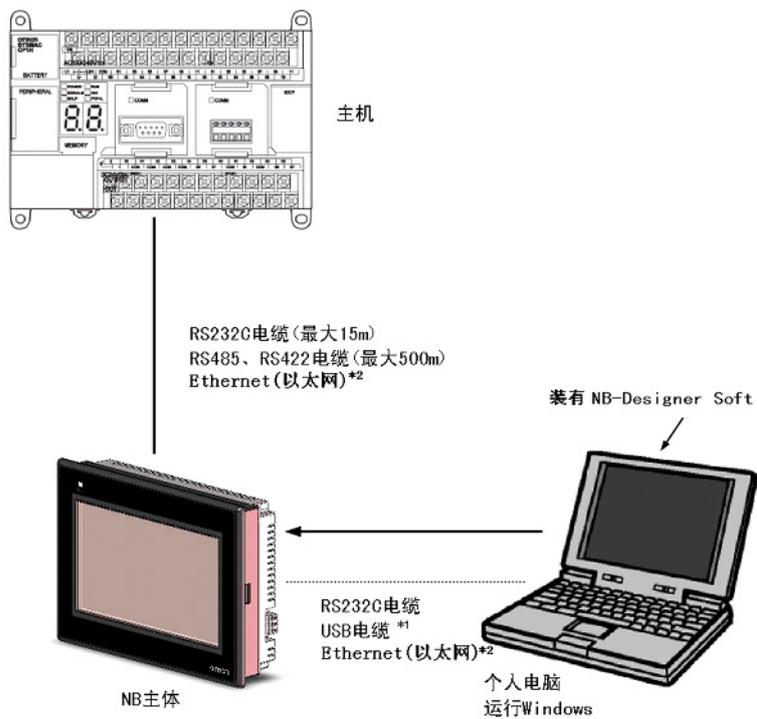
\*1 用 USB 连接 NB 主体和电脑时，请参阅 NB 系列 安装手册的【2-3-2 通过 USB 进行连接】章节。
