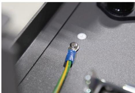
图21：固定地线和控制柜
