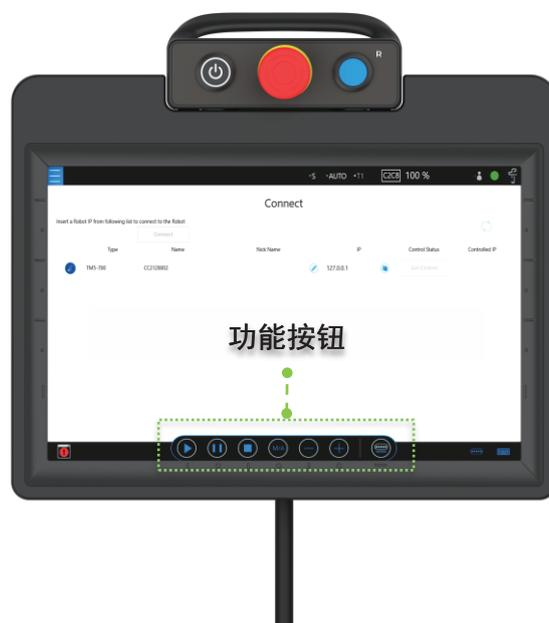
图27：TM示教器（由TM Screen和机器人操纵杆组成）
