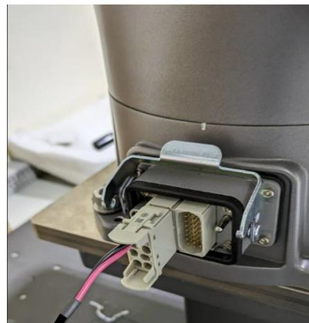
图3：外部制动器释放设置（使用机器人底座）
