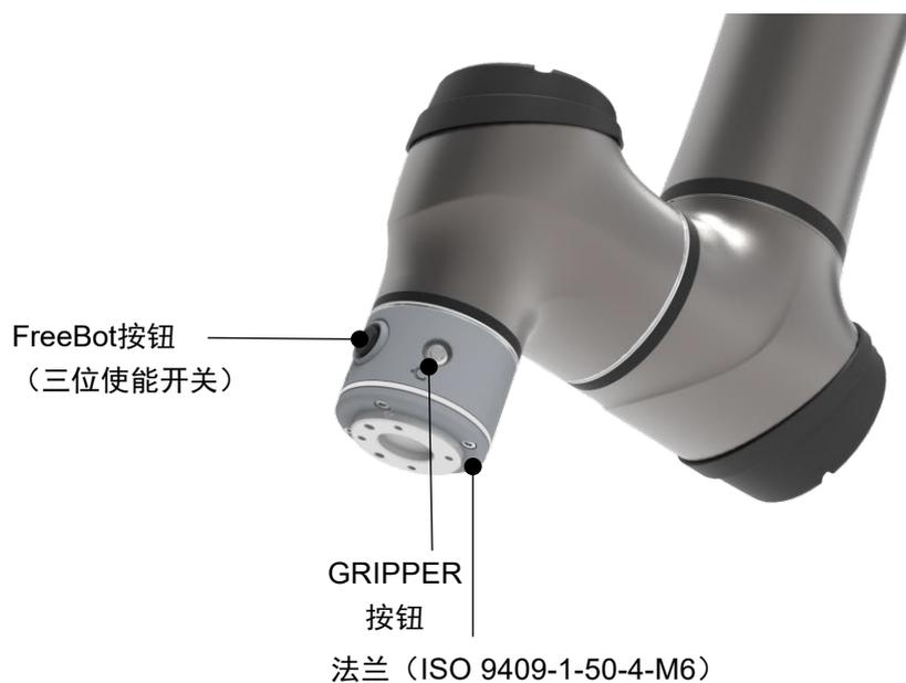
图16: TM25S-X末端模块组件参考图
