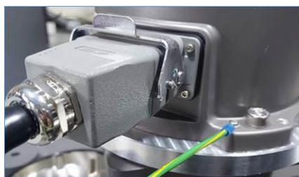
图14：机器人的接地位置
