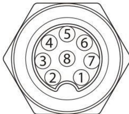
表15：机器人的8引脚数字I/O连接器
