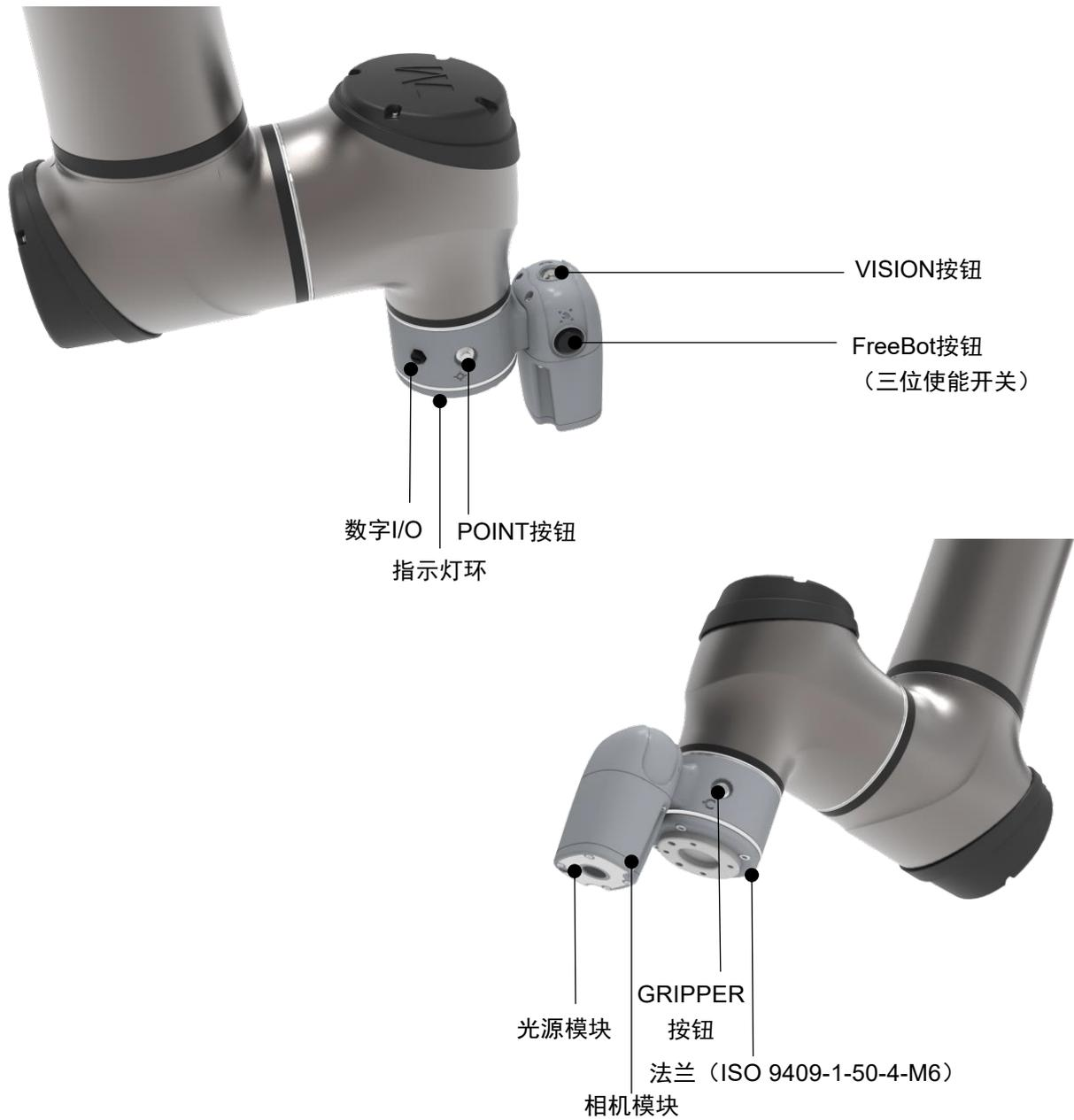
图15: TM25S/TM25S-M末端模块组件参考图
