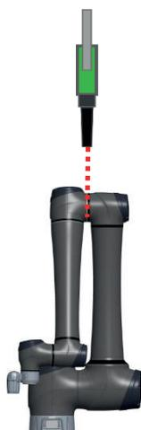
4. 将机器人妥善固定在安装位置后，使用M12螺丝和垫圈将底座安装在安装面上。
