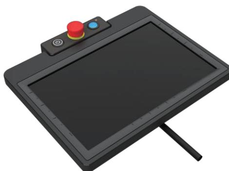
2. 旋紧TM Screen背面的两个手动螺丝，确保将该模块牢固地与机器人操纵杆结合。
