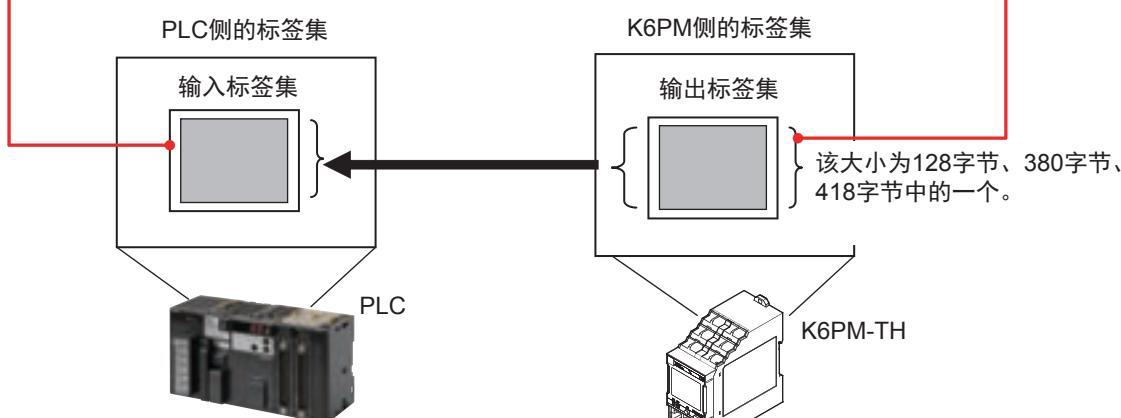
创建与右侧选择的K6PM内部数据大小128字节、380字节、418字节中的一者一致的标签，并直接将其设定为输入标签集。
