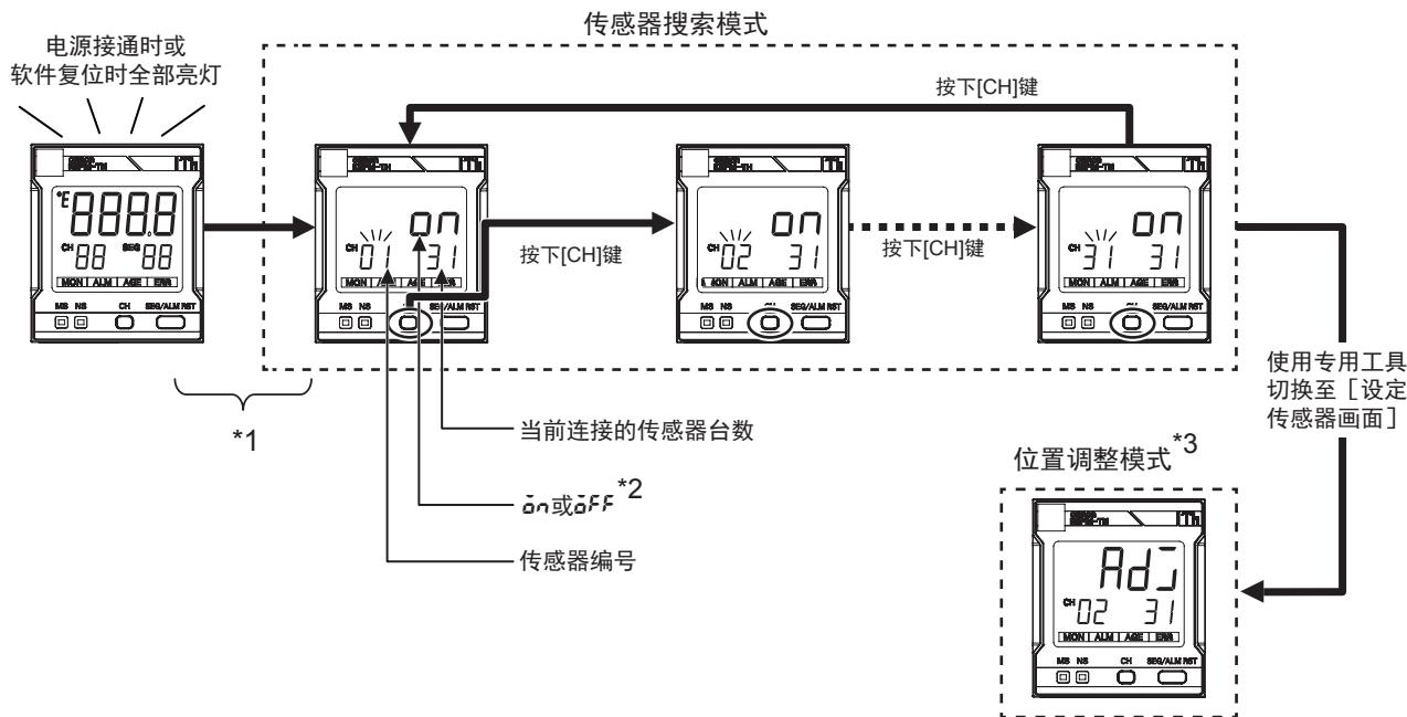
\*1. 电源接通或软件复位后，计算出所有的温度数据最多需约 30 秒。
