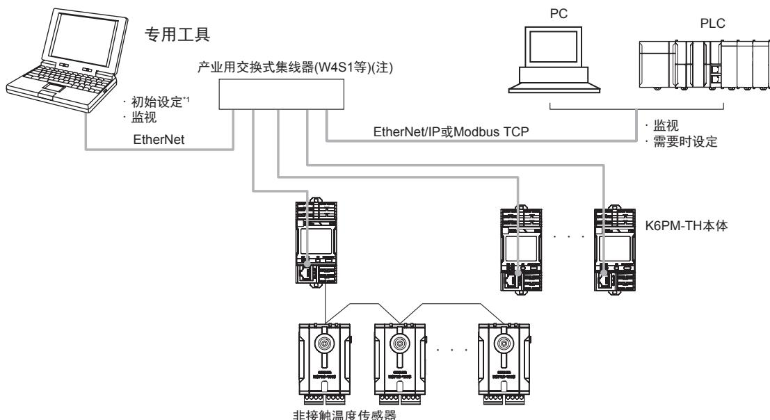
(注) 初始设定时, 不通过交换式集线器, 使用 Ethernet 电缆 1 对 1 连接各 K6PM-TH 本体。
