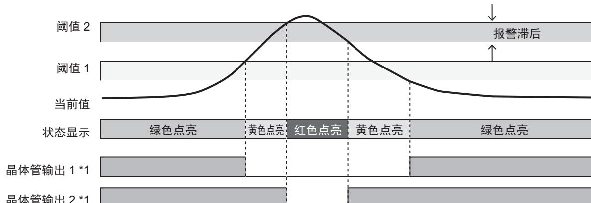
(注) 以上为 1 个当前值的示例。实际使用时，根据多个当前值进行个别报警判定，OR 逻辑结果将作为综合报警反映至状态显示及晶体管输出。
