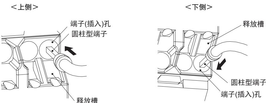
单线较细而难以连接时，请像绞线的连接方法一样使用一字螺丝刀。
