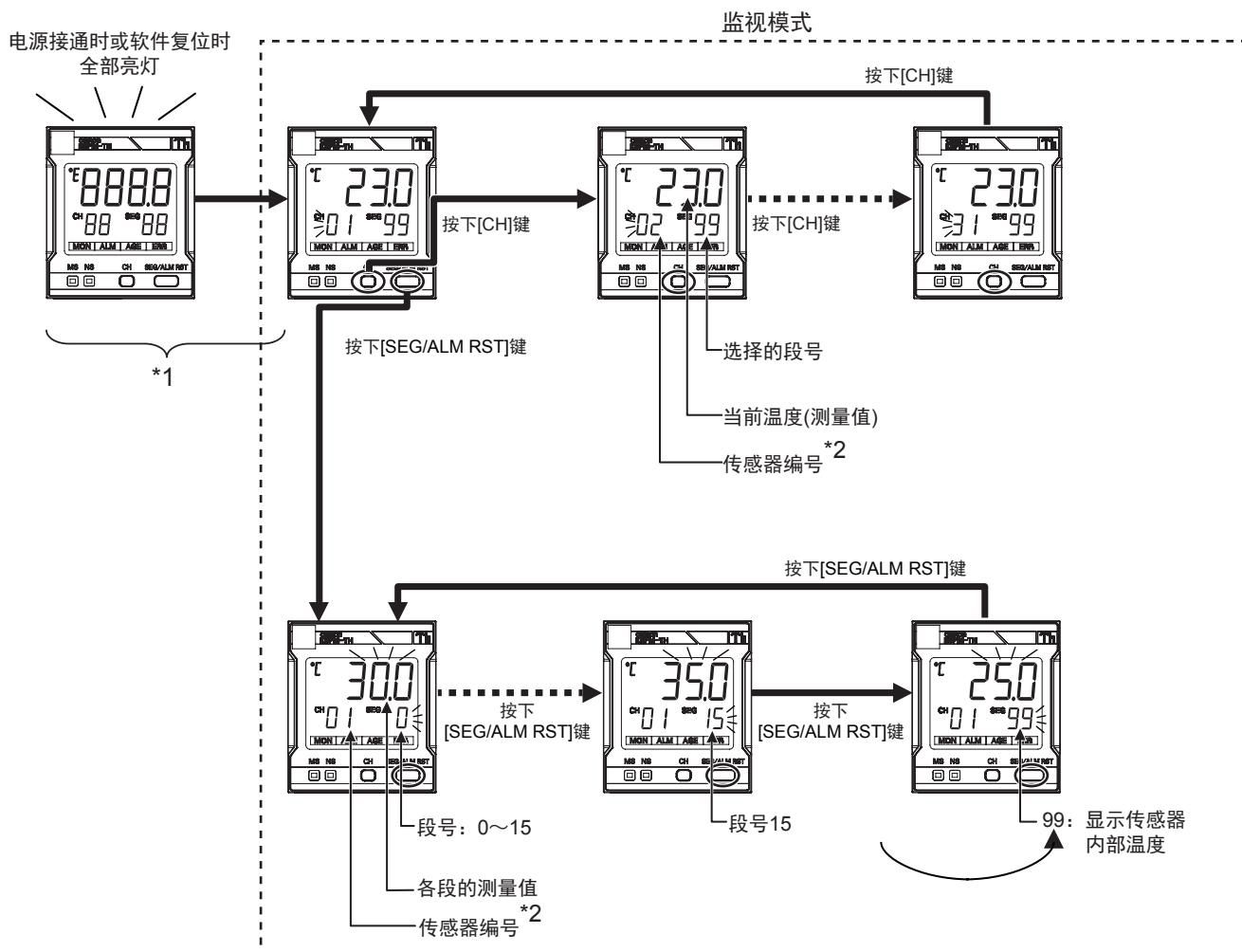
\*1. 电源接通或软件复位后，计算出所有的温度数据最多需约 30 秒。
