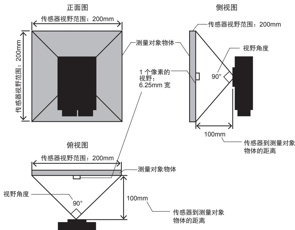
此外，非接触温度传感器与测量对象物体的距离请考虑测量对象物体产生的电压及安全标准认证等进行设定。
