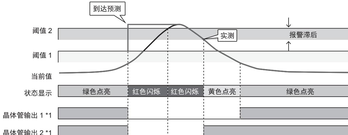
(注) 以上为 1 个当前值的示例。实际使用时, 根据多个当前值进行个别报警判定, OR 逻辑结果将作为综合报警反映至状态显示及晶体管输出。
