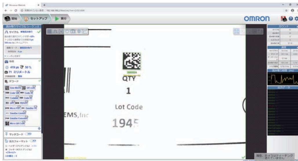
如下所示，通过单击[自动对焦]图标，选择[点对焦]图标，将自动调整读码器的焦距。
