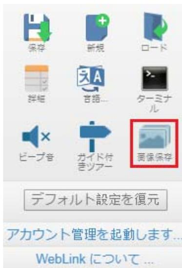
单击应用设定菜单中的 [图像保存] 图标后，将显示以下对话框。
