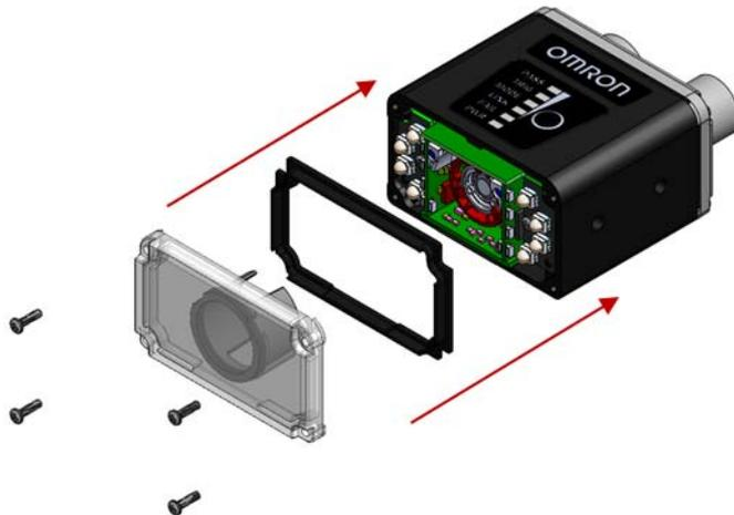
● 安装MicroHAWK V/F430-F更换用前盖（环形照明用）、扩散板（环形照明用）、光源选装件（环形照明用）
