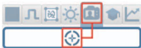
自动调整读码器的焦距后，单击[示教]按钮并选择[目标]图标，如下所示。
