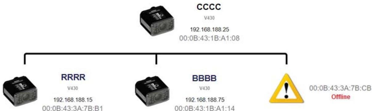
如果在显示上图所示状态时打开了C3的电源，应用将自动解决问题，并新建包含C3的完整菊花链。此时，无需重新启动浏览器或母设备。
