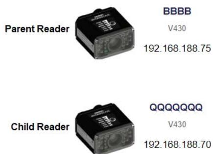
可创建的菊花链数量没有限制。当前处于激活状态的所有菊花链都将显示在DDU菊花链页面上。单击菊花链后，将打开弹出窗口信息。此弹出窗口包含有关菊花链配置的信息，包括组信息、母读码器ID和子读码器ID。菊花链信息弹出窗口还包括 [Delete] 按钮，用于删除整个母和子读码器的菊花链配置。
