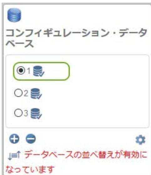
注：在WebLink用户界面中将配置数据库设为有效的主要方法是打开高级设定对话框并增加活跃索引的数量。或者可以使用终端，通过<K252>指令设定索引数。如果活跃索引不存在，「配置数据库」视图将变为隐藏。变为可用后，将通过高级设定或终端显示配置数据库。删除最后一个索引后，将显示警告对话框。
