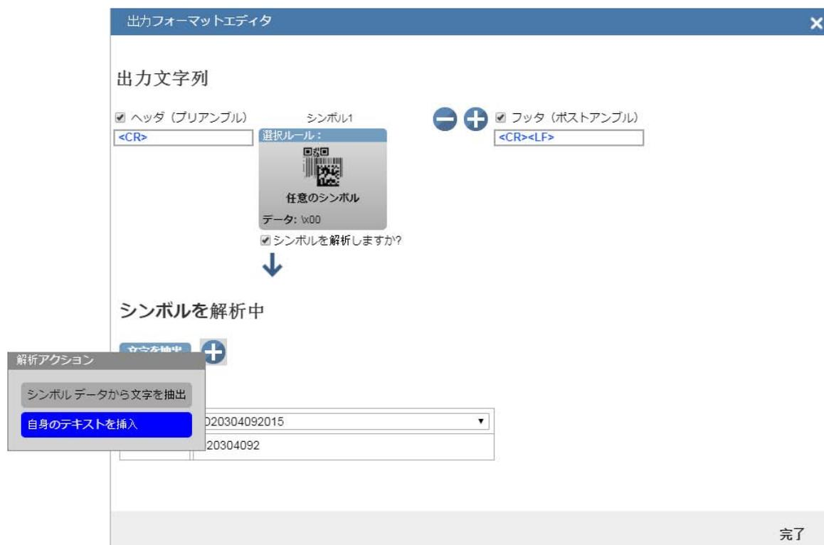
在上面的图像中，可以看到〔输出字符串〕中的〔标题（前导）〕和〔页脚（后导）〕之间会显示“过滤器”。单击过滤器进行定义。这里最重要的字段是〔数据〕。在上面的示例中，数据字段中显示〔\x00〕。在数据字段中输入字符时的规则与在比较字符串数据库中输入字符时的规则相同。将文本、通配符和占位符组合，使其与条形码匹配。
