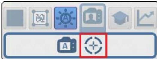
单击点对焦图标, 将显示用于选择自动对焦图像位置的信息。
