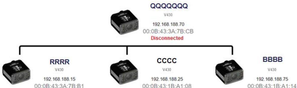
如果菊花链中的子读码器断电，即使是暂时关闭，读码器地图中对应的子读码器下方也会出现离线通知。重新打开电源后，离线通知消失。
