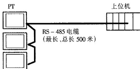
**注意** 电线的一端必须一直连接至上位机(PC),并且不能有支线。支线会引起诸如传输延迟和通信错误等问题。
