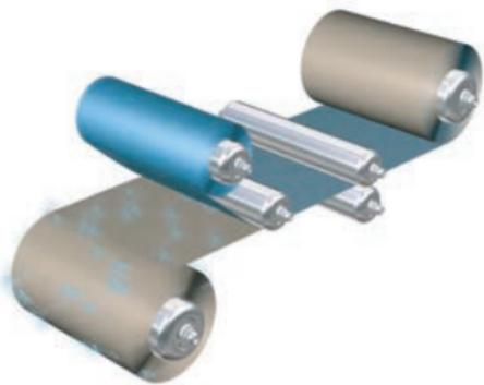
**POINT!** 在重复摩擦和剥离的制造现场工程中产生较多的静电。
