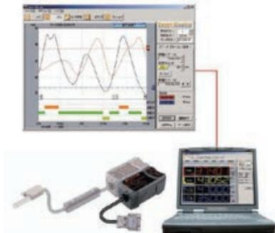
液晶基板等带电量不均一地对象物，采用多点测定非常有效。形ZJ-SD能够连接5台放大器，所有数字能用计算机传送。
