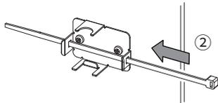
Step3: ケーブル(アナログセンサ側とIO-Link通信側)を両側に取り付けてください。
