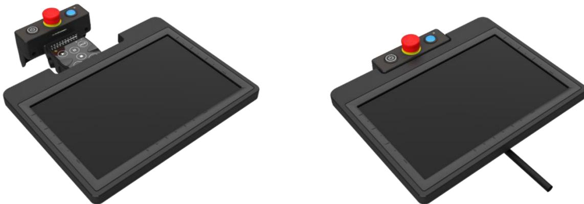
3. 旋紧 TM Screen 背面的两个手动螺丝，确保将该模块牢固地固定在机器人操纵杆上。
