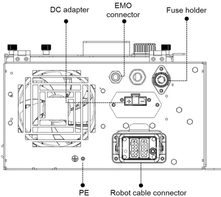
图 63: TM12S-M SEMI/TM14S-M SEMI 紧急关机接口
