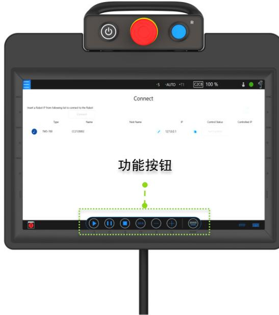
图 26：TM 示教器（由 TM Screen 和机器人操纵杆组成）
