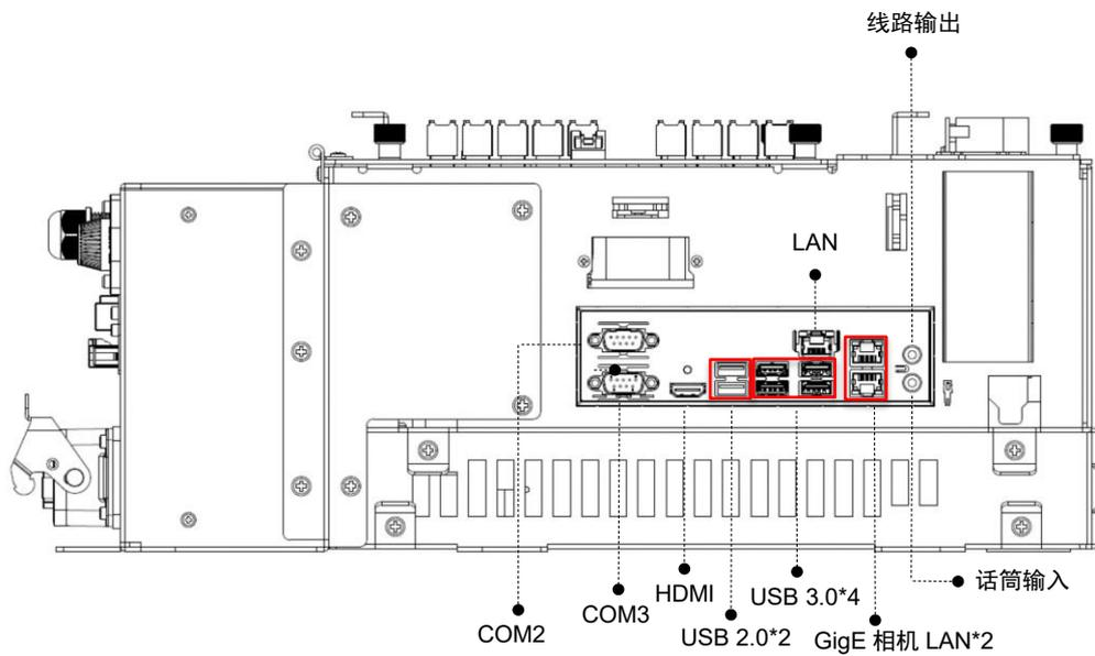
图 60: TM12S-M/TM12S-M SEMI/TM14S-M/TM14S-M SEMI 系列的接口
