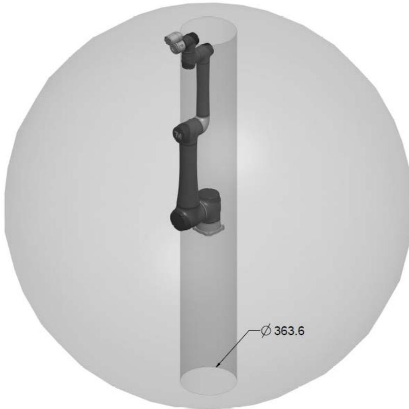
图 9: TM12S/TM12S-M/TM12S-X 运动范围的示意图
