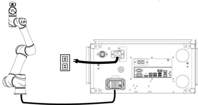
图 71：连接机器人和控制柜
