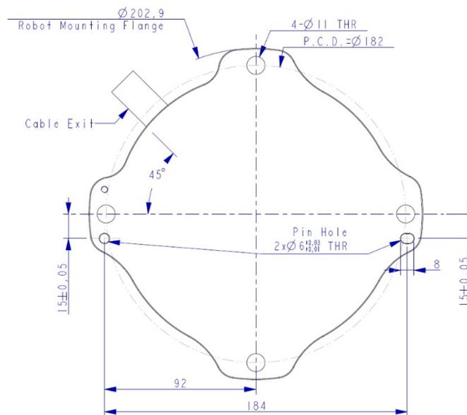
图 16: TM12S/TM14S 系列机器人底座的底视图
