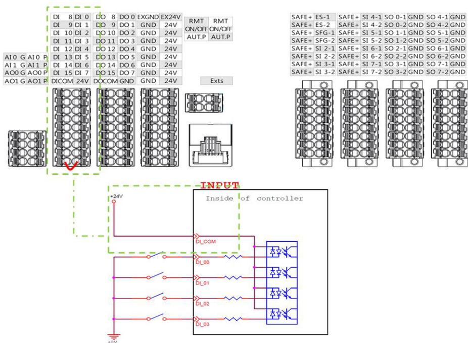
图 41：设置为 Sink 电流输入类型
