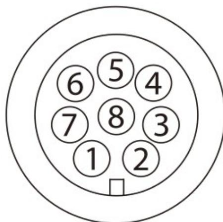
\*M8/8PIN 连接器符合 IEC 61076-2-104 规定。
