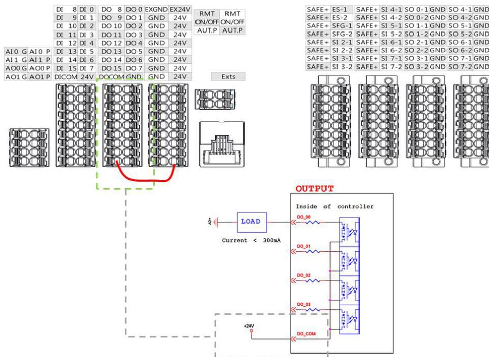
图 45: 设置为 Source 电流输出类型
