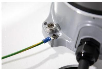
图 17: 机器人接地处
