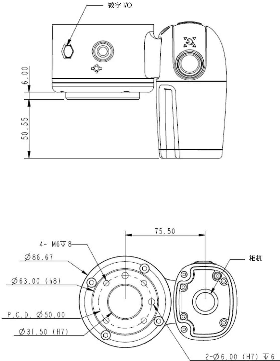
图 20: 机器人末端法兰表面参考图
