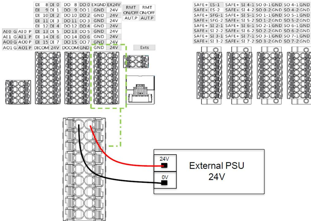
图 39: 电源连接器
