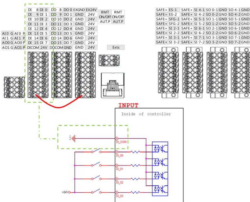
图 42：设置为 Source 电流输入类型
