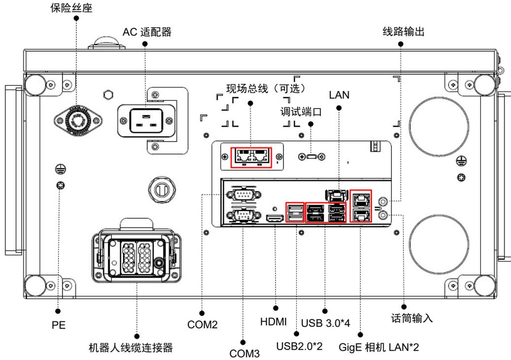
图 59: TM12S/TM14S/TM12S-X/TM14S-X 系列的接口
