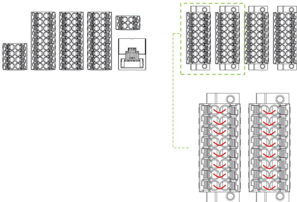
图 33：安全输入连接器
