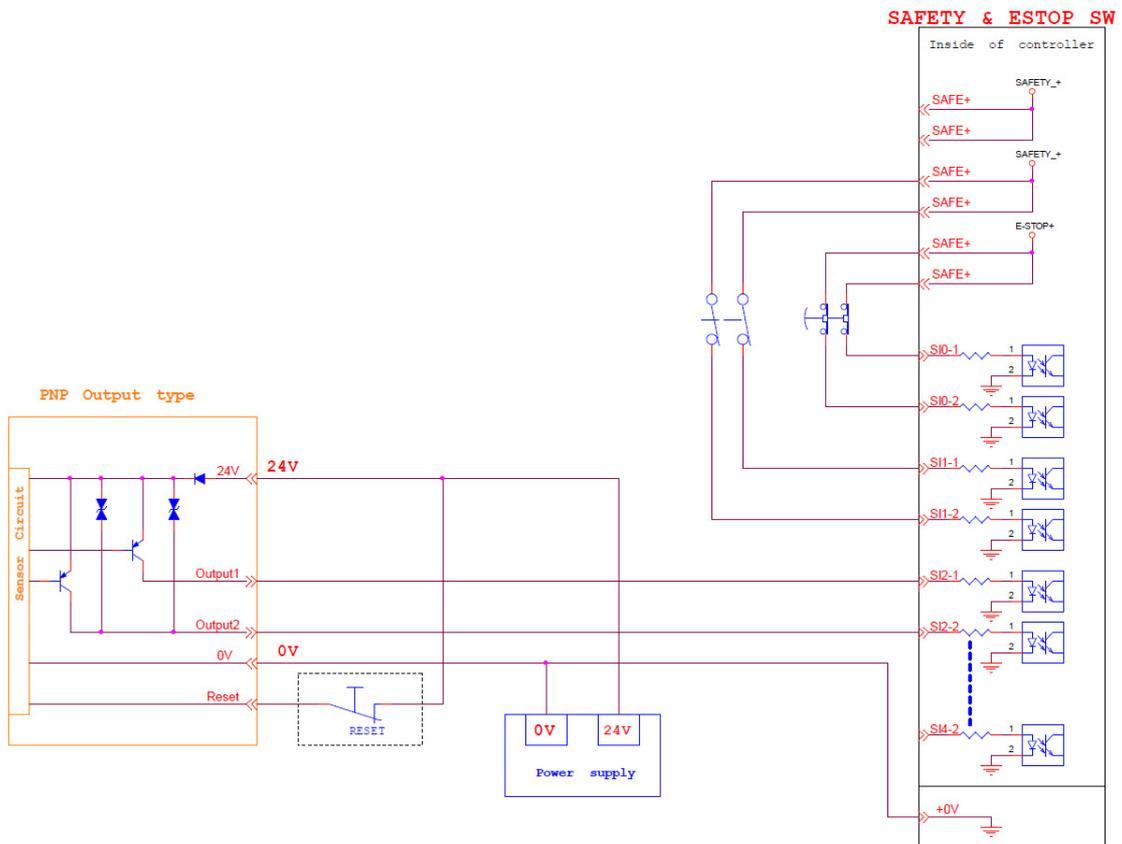
图 35：PNP 输出式安全装置的接线图示例
