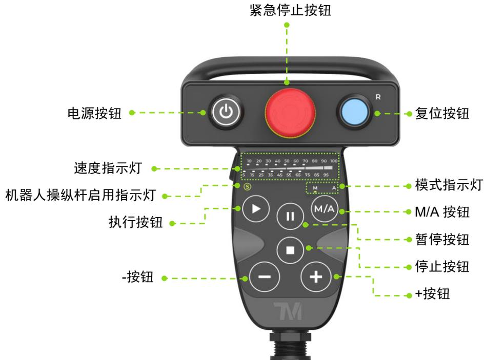
图 23：机器人操纵杆（正面）
