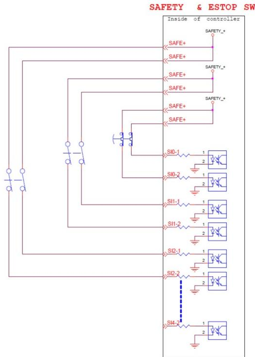
图 34：开关式安全装置的接线图示例
