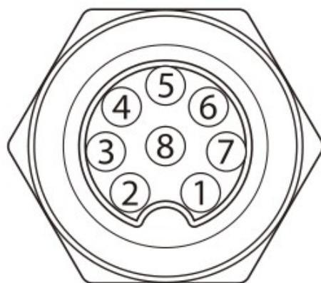
表 12: 机器人的 8 引脚数字 I/O 连接器
