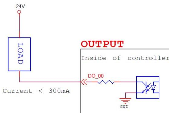
图 51：连接工具端数字输出
