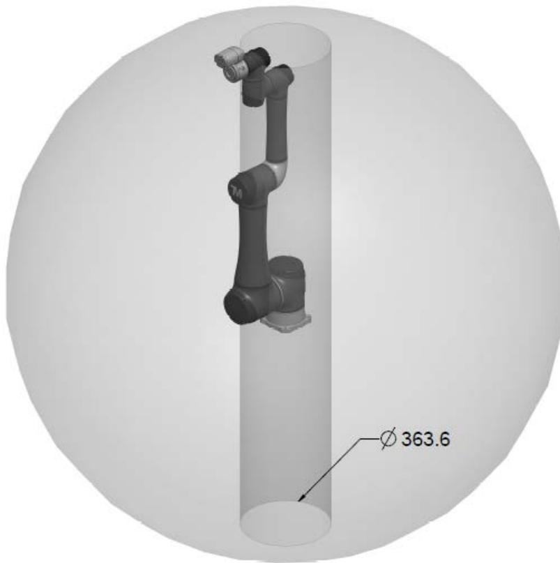
图 12: TM14S/TM14S-M/TM14S-X 运动范围的示意图
