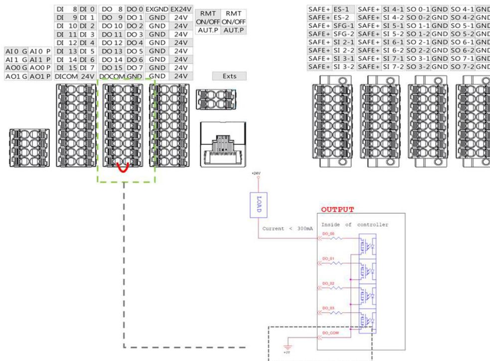
图 44: 设置为 Sink 电流输出类型
