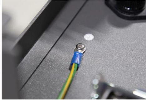
图 22：固定地线和控制柜
