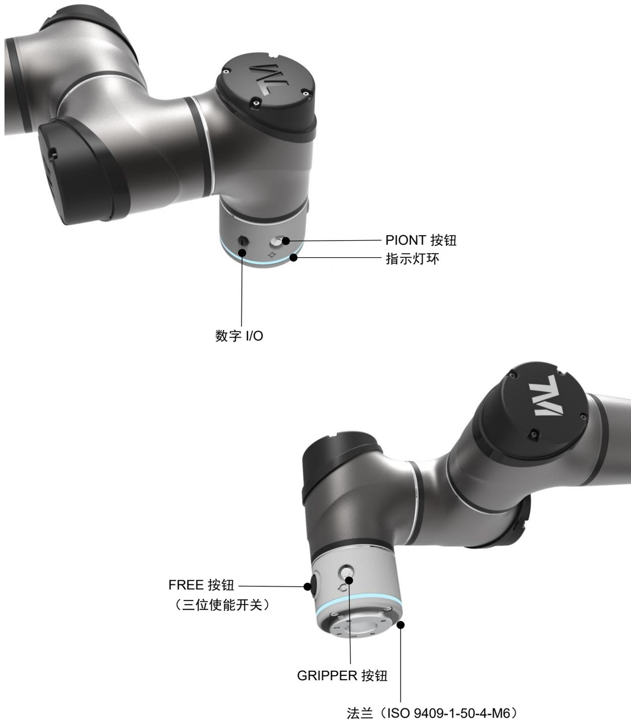
图 19: TM12S-X/TM14S-X 末端模块组件参考图
