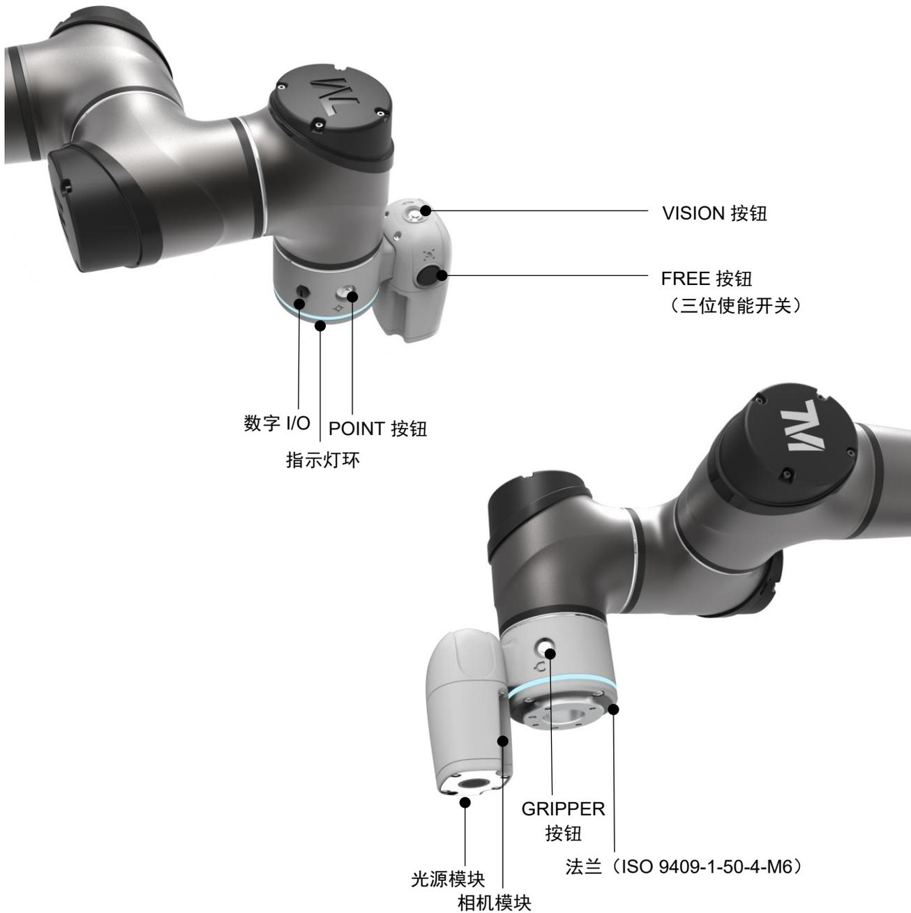
图 18: TM12S/TM12S-M/TM14S/TM14S-M 末端模块组件参考图
