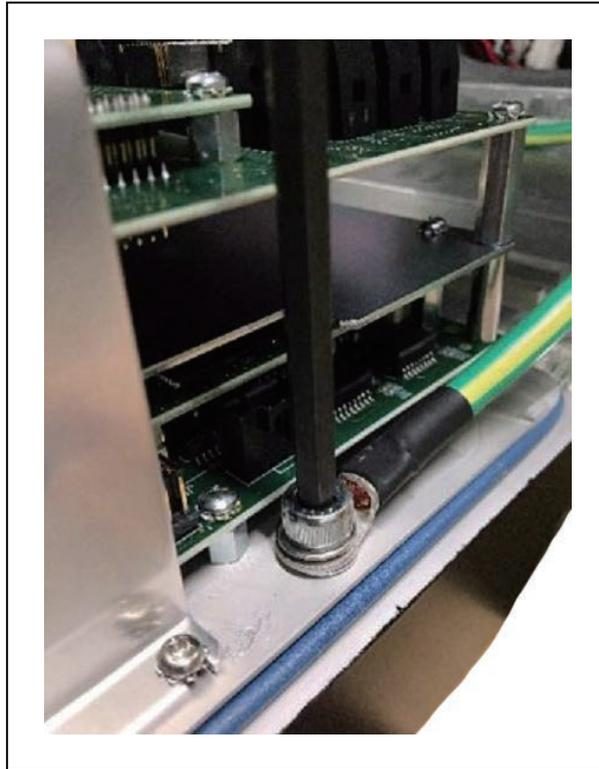
图 7-12. 使用 5 mm 六角扳手拆除 iCS-ECAT 放大器底盘上的地线螺钉
