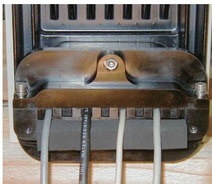
图9-7. 安装完成的上部法兰
