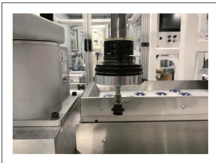
图 5-1. 已安装吸盘末端执行器
