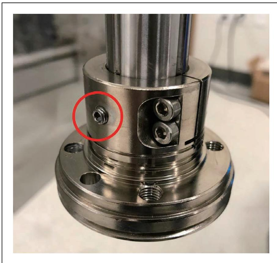
图 7-8. 工具法兰固定螺钉
