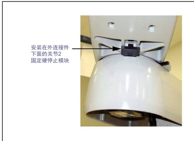
图 5-17. 安装在外连接件底部的关节 2 固定硬停止块
