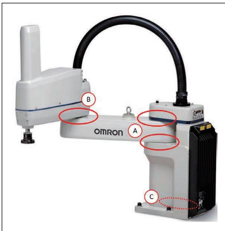
图 7-5. eCobra 漏油检查区域
