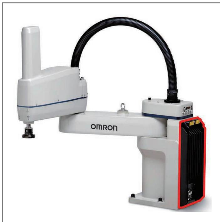
图1-3. eCobra机器人（其中高亮显示的为iCS-ECAT）
