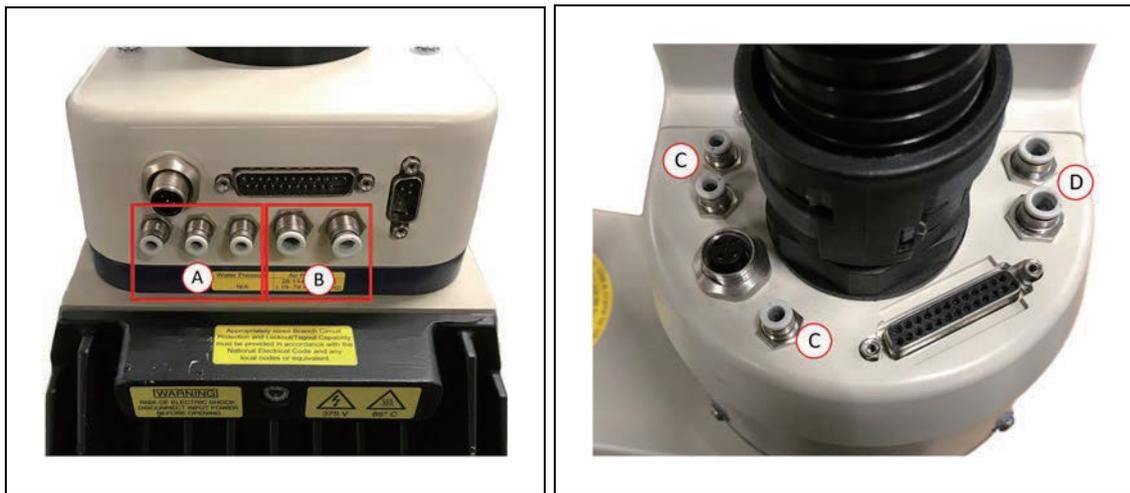
图 1-7. 关节 1（左）的背面和关节 2（右）上的气动直连端口
