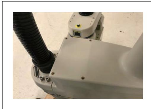
图 5-3. 外连接件（顶部）的外部工具安装位置
