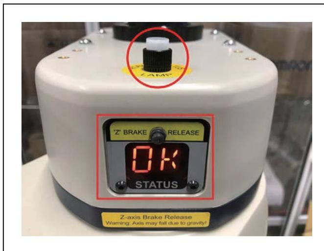
图 6-2. 机器人状态 LED 和显示面板
