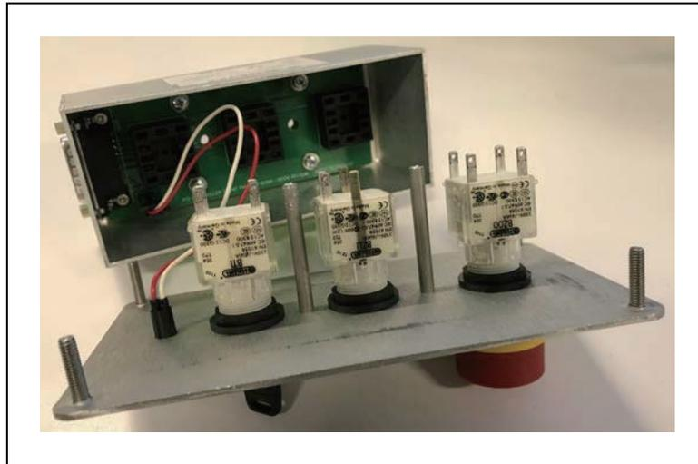
图 7-15. 前面板背面（注：已连接 LED 电线，左）
