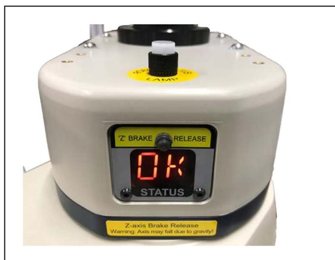
图 6-7. 机器人状态显示屏和 LED
