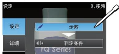
将用作测量参考的对象置于照相机前。移动矩形框，使位置补偿的特色部分位于矩形框内。
