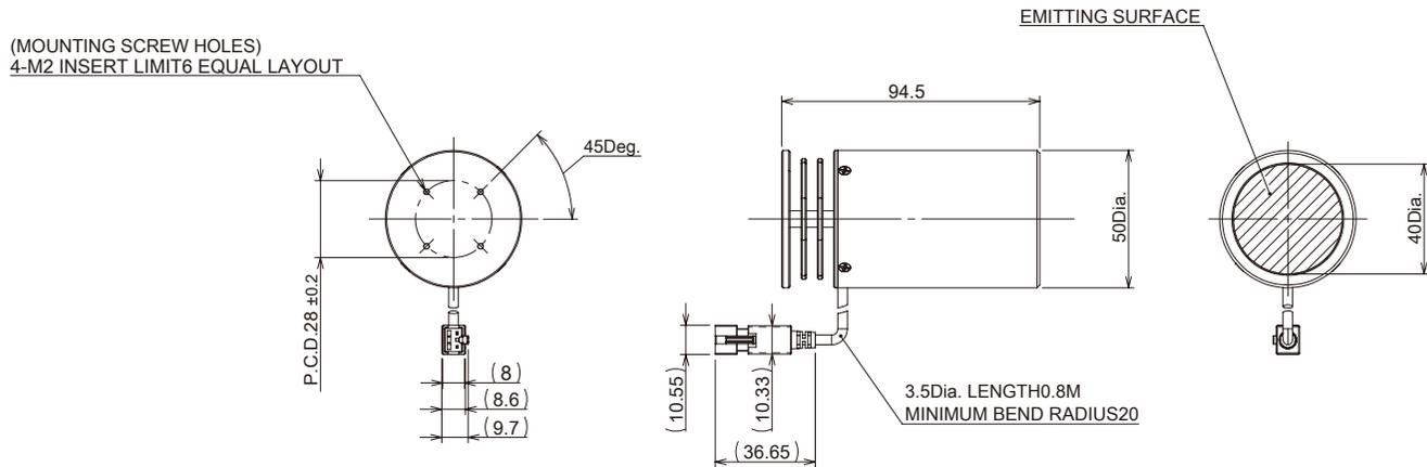
Tightening torque: 0.15N · m
