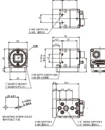
※カメラの底面についている台座は、底面、天面、両側面に取り付けることができます。 台座取り付けねじ(M2×7)を外し、取付け位置を修正してください。 (取付けねじ推奨トルク:0.23N·m)
