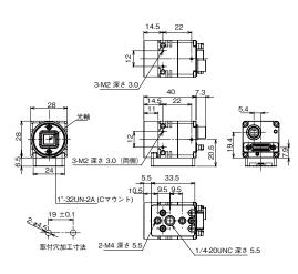
※カメラの底面についている台座は、底面、天面、両側面に取り付けることができます。 台座取り付けねじ(M2×7)を外し、取付け位置を修正してください。 (取付けねじ推奨トルク:0.32N·m)
