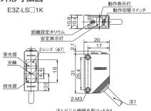
注1.ビニル絶縁丸形コードゆ4 4芯(導体面積:0.2mm²/絶縁体径:ゆ1.1) 標準長さ:2m, 0.5m
