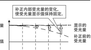
推荐将“输出切换”設定成D-ON(Dark ON)。当光量调整功能開啟设定为OFF时/智能调整出错时/执行最大灵敏度调整时, DPC功能无效。
