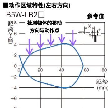
如5.1 模拟信号输出中所记载的, 根据本传感器的光学特性, 检测光泽物体时需要考虑角度的影响来安装传感器。以下所示为数字信号输出的角度特性图(参考值)。该特性图通过将检测物体在倾斜状态下靠近传感器(Light ON型), 测量变为ON的点而得。
