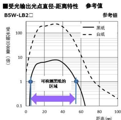
数字信号输出的动作区域特性图(参考值)如下所示。该图表示当检测物体从传感器前通过时, 在哪个点发生动作(Light ON时, 从OFF变为ON的点)。要检测移动物体时, 一般在左右方向(与投受光轴的面垂直的方向)上安装传感器。
