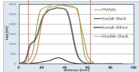
B5W-LB系列是限定反射型传感器, 搭载了由4种超环面透镜组成的欧姆龙自行设计的光学镜头。只需微弱的反射光即可实现稳定检测, 不易受检测物体的颜色和表面状态影响, 可在广泛检测区域内检测黑纸和透明玻璃等。
