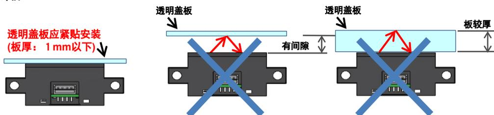
不得不离开传感器安装透明盖板的情况下，请研讨以下措施。参阅数据表的倾斜特性图，按一定角度进行安装，以消除透明板内、外表面反射光的影响。但是，该对策可能会因透明盖板的伤痕和水滴、脏污、灰尘附着等而产生漫反射光导致始终为入光状态。
