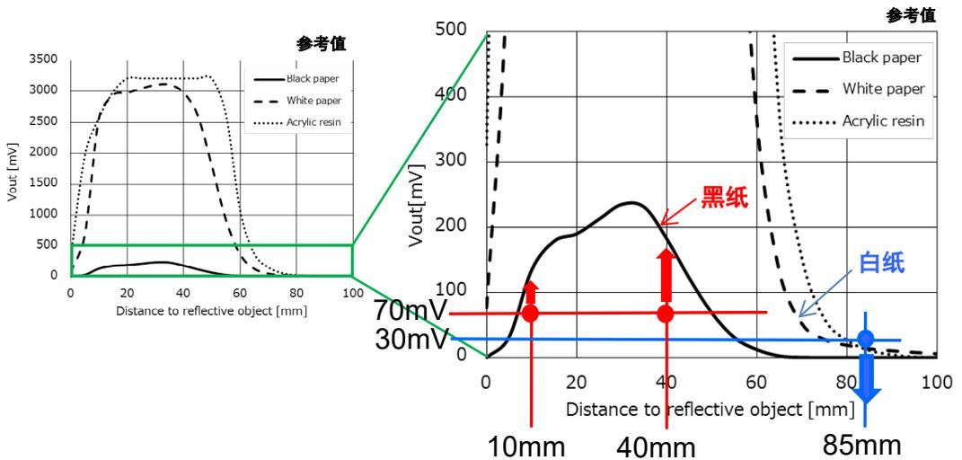
在实际设备的结构设计方面，请参阅该受光输出-距离特性图，设定传感器与检测对象物体之间的距离。检测物体的位置不发生变动时，建议将传感器安装在该特性曲线的峰值位置。
