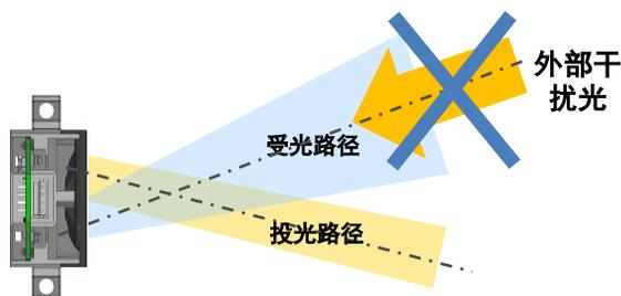
3. 出于防尘、防水等目的在传感器前面安装透明盖板时，请务必紧贴传感器的投受光面进行安装。此时，根据板厚，透明板的内、外表面的反射光会进入传感器，需要使用实际设备进行确认。特别是超小型产品检测距离短、数字信号输出无法调整阈值，需要对安装偏差、个体差异、设备使用过程中的透明盖板伤痕和水滴、灰尘等的影响等进行充分评估。
