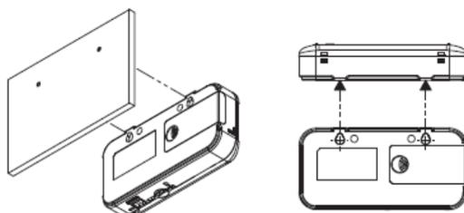
请使用 M3 螺钉、将螺钉头挂在螺钉悬挂孔。螺钉头底面和墙面之间请保持 2.5mm 以上的间距。
