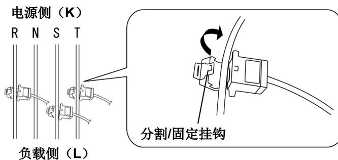
3) 使用型号 ZN-CTM□□-□A 时，与另售的分支电缆型号 ZN-CTM11-C 连接。此时，请使用与测定电路的相线制相符的分支电缆连接插口位置。
