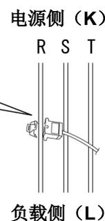
使用通道数为“2CH”时，单相 3 线制状态下请夹紧 CH1 的 R 相、CH3 的 S 相。而三相 3 线制状态下则请夹紧 CH1 的 R 相、CH3 的 T 相。
