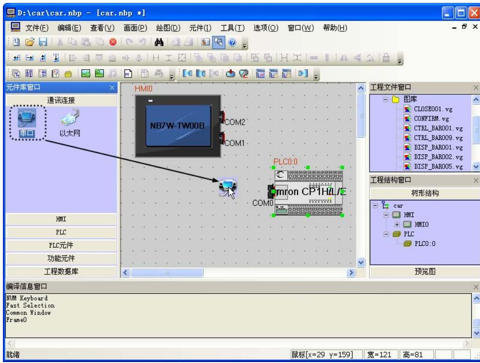
**5 在设计窗口移动 HMI 和 PLC，使串口的通信线连接到 HMI 的 COM1 和 PLC 的 COM0。**
