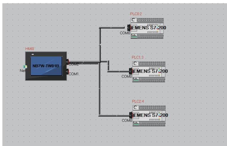
假设 NB7W 的 COM2 口连接三个 S7-200PLC，他们的站号分别是 2、3、4；如果站号为 2 和 4 的 PLC 通信没连上，则内部寄存器 LW.B9432.2 和 LW.B9432.4 会自动置 ON，如下图所示：
