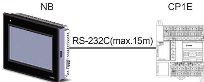
注 请使用欧姆龙 PT-PLC 连接电缆。使用其他电缆可能会导致故障
