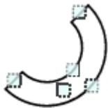
在圆弧的端部、圆弧内侧圆和外侧圆及圆弧内部显示点。
