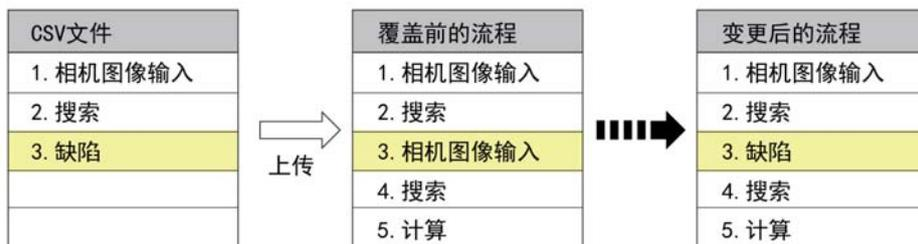
就这样，单元 3 的处理项目将从相机图像输入变更为缺陷。CSV 文件内不存在的部分（流程中 4. 搜索处理项目、5. 计算处理项目）不会被变更。
