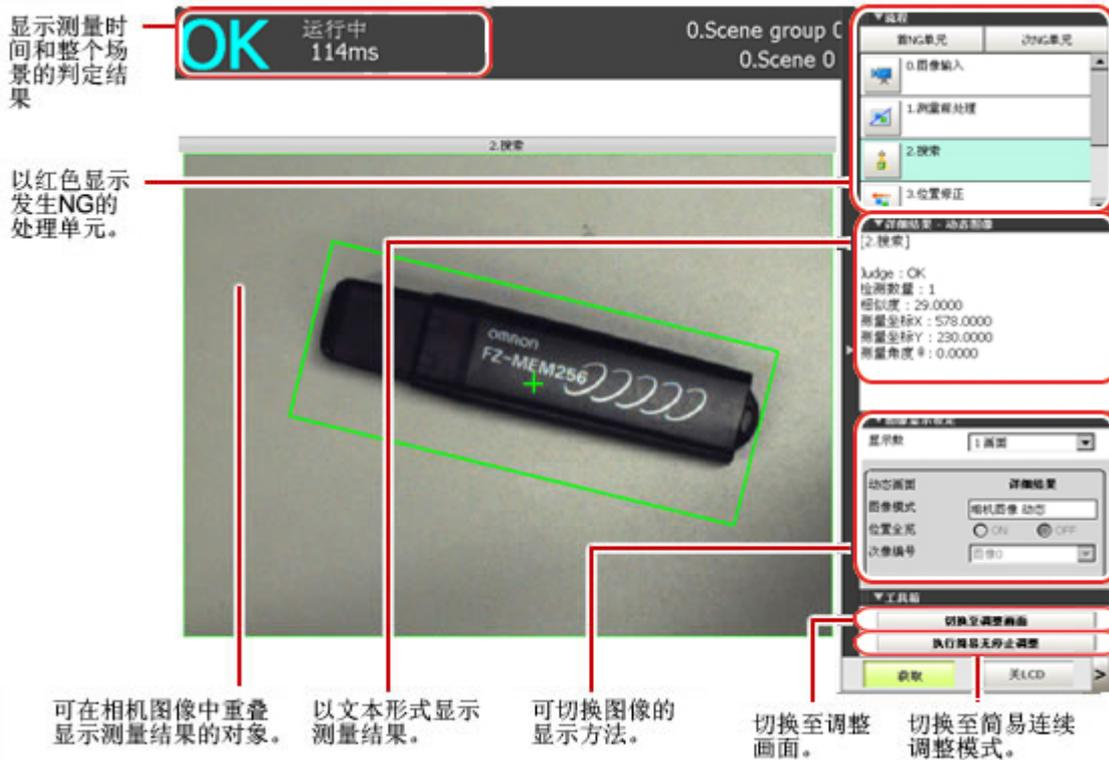
处理时间较长时，必须重新设定处理项目和设定值。测量结果中也会显示测量处理时间，请参考。
