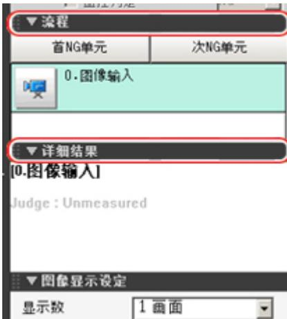
2. 同时显示流程和详细结果时，可以通过拖动 [ 详细结果 ] 来变更流程和详细结果显示区域的尺寸。
