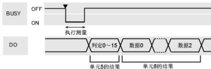
[注1]：操作模式（仅限于 FZ4-11 □□ / H11 □□）为 [ 双线随机触发模式 ] 时，线路0使用 DO0 ~ DO7，线路1使用 DO8 ~ DO15。关于并行判定输出的设定，请对线路0，线路1的计算式0~7设定想输出的判定结果。
