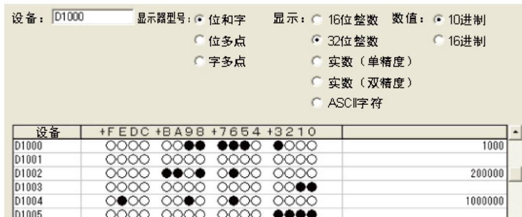
\*: 按照10进制 1CH 单位时，将以如下方式保存在 PLC I/O 存储器中。
