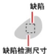
增大 [ 缺陷检测尺寸 ] 可缩短处理时间，但会降低测量精度。
