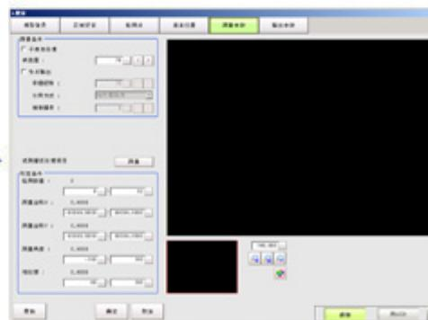
设定在流程中的处理单元(在场景中注册的处理项目)的条件设定画面。也可从主画面(调整)直接显示此画面。
