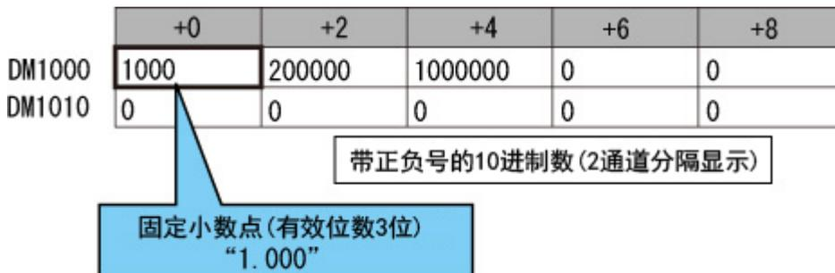
\*: 按照10进制 1CH 单位时，将以如下方式保存在 PLC I/O 存储器中。
