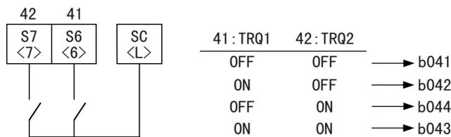
低速区下使用转矩限制功能时, 请同时使用过载限制功能 (b021/b221/b024)。
