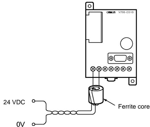
**Wiring RESET Signal**
