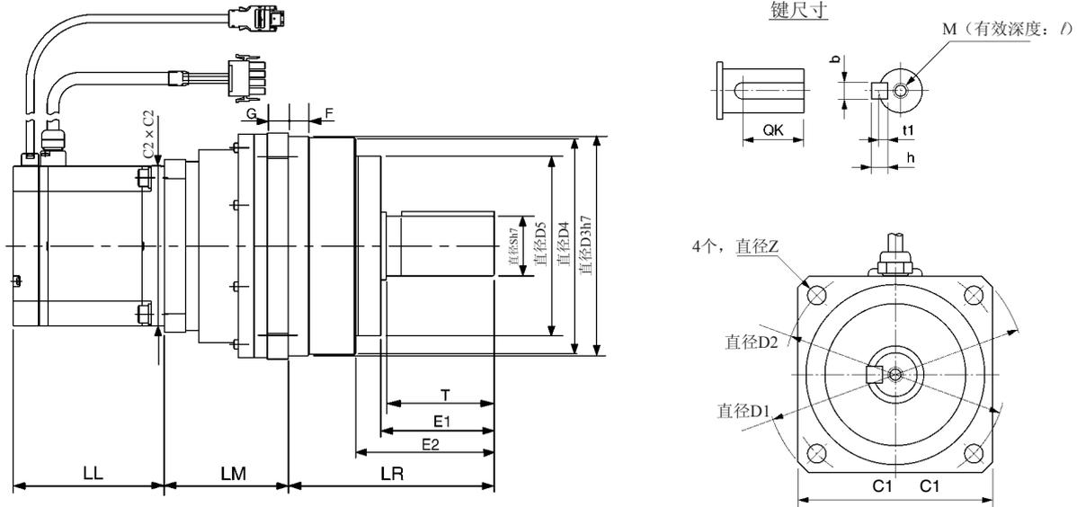
● 带标准齿轮的1,000-r/min伺服电机 (300~3 kW)
