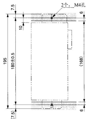
■ 三相200 V: R88D-WT05H/-WT08H/-WT10H (500 W ~ 1 kW)
