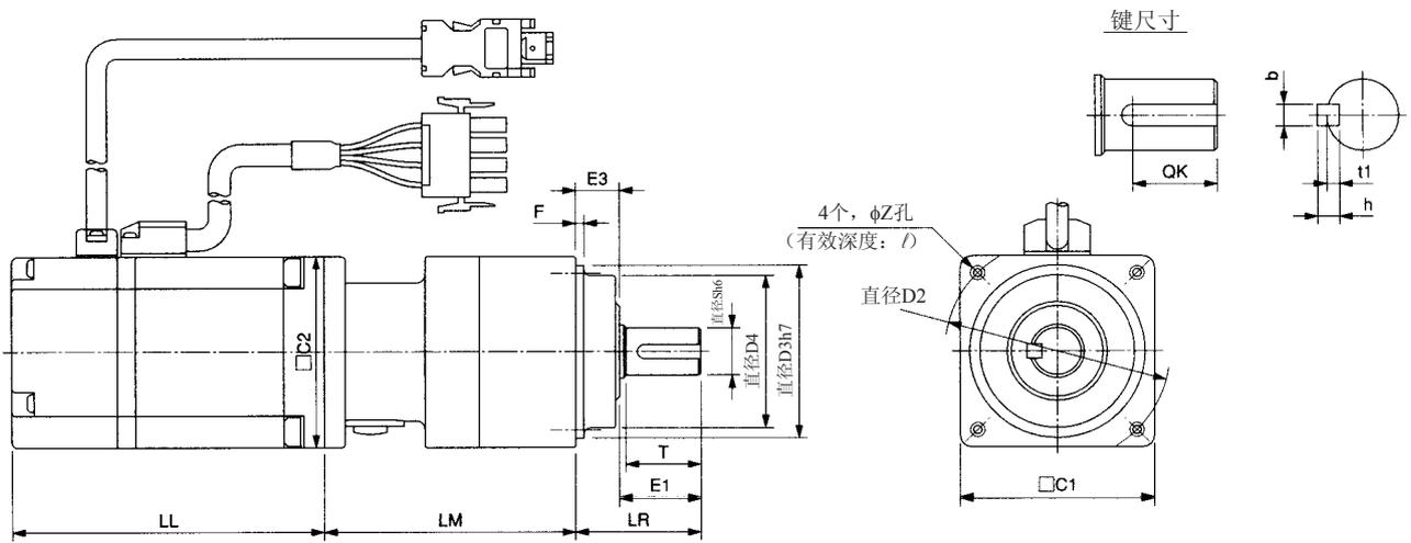
● 带经济型齿轮的3,000-r/min扁平型伺服电机（100~750 W）
