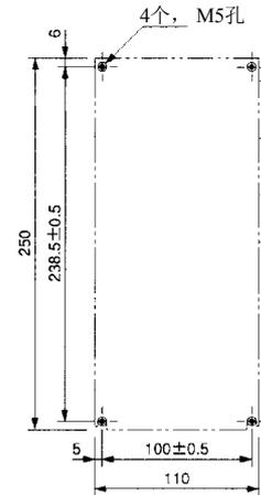
● 前面板安装 (使用安装托架)
