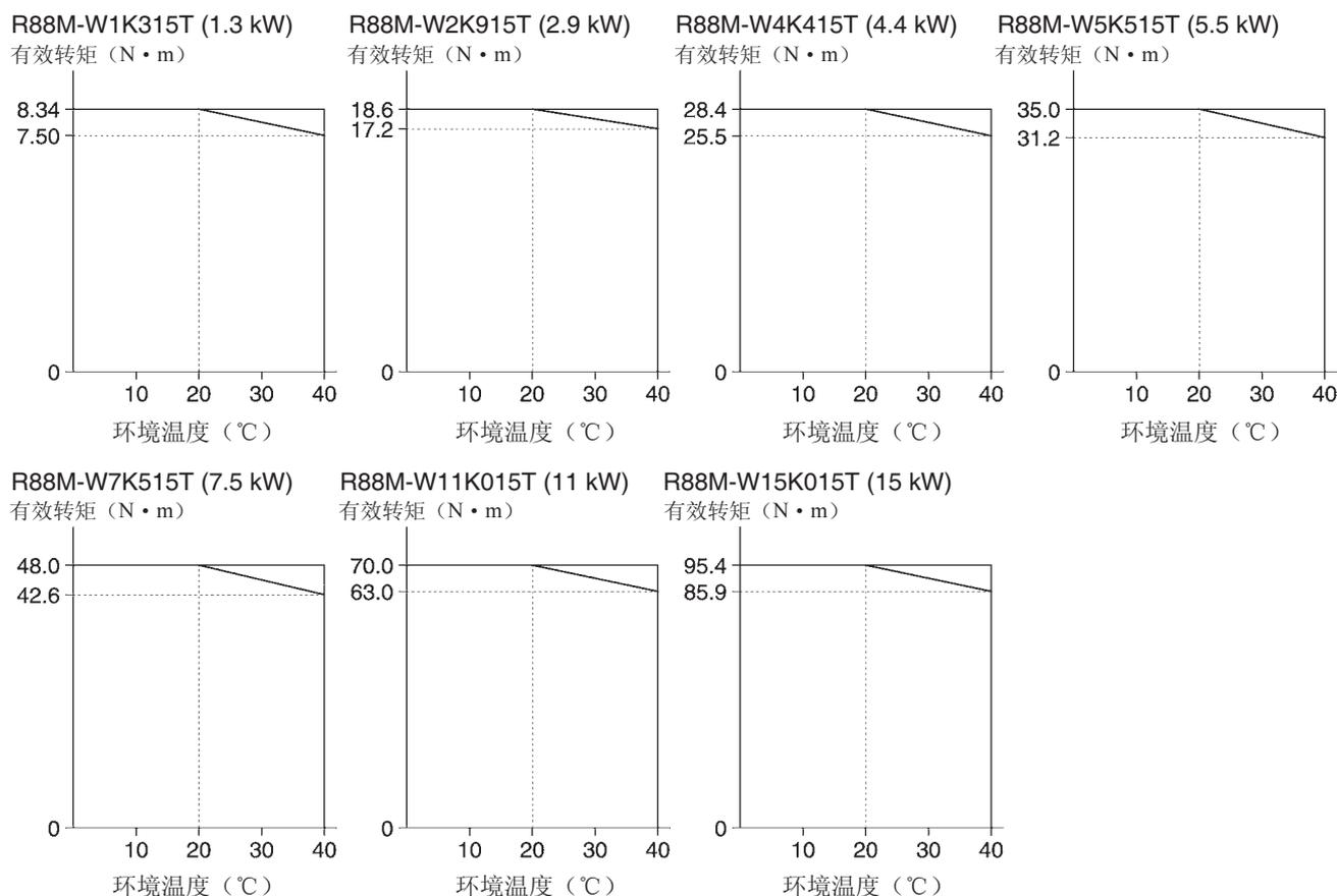
2-5-3 带减速齿轮的伺服电机规格
