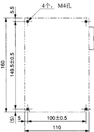
● 前面板安装 (使用安装托架)
