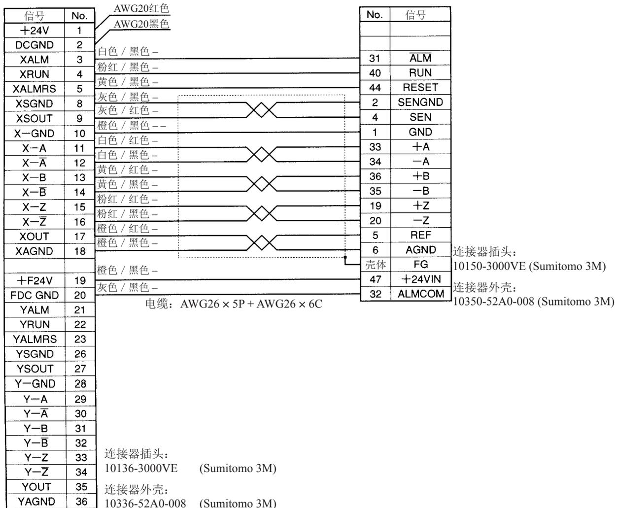
注 1. 控制器的符号是DRVX-Y连接器的符号。在DRVZ-U连接器中，X → Z，Y → U。
