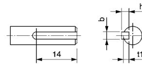
带键和螺纹孔的轴端尺寸 (-S2)
