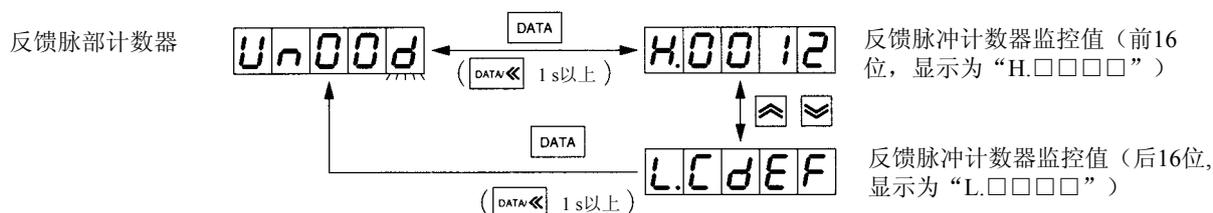
操作步骤示例：反馈脉冲计数器（Un.00d）监控值显示
