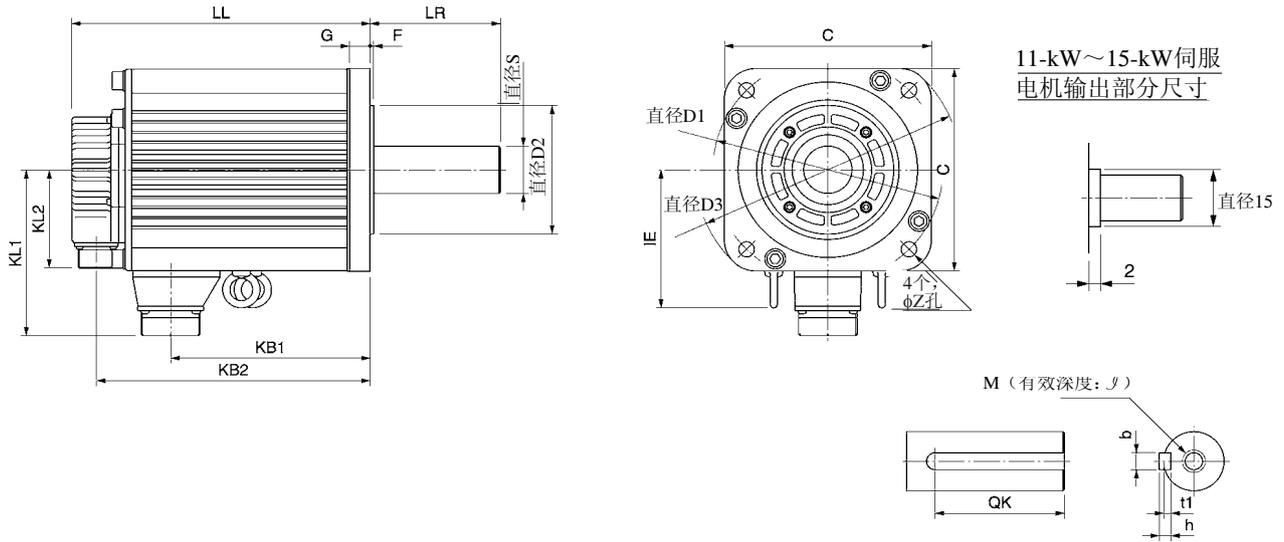
11-kW~15-kW伺服电机输出部分尺寸
