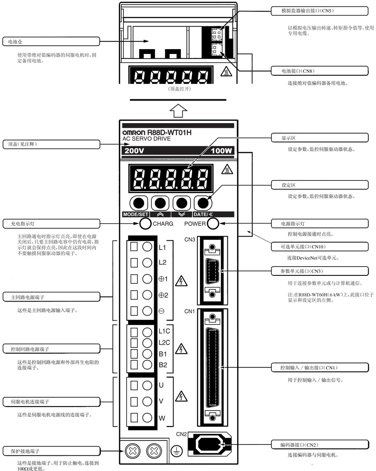
注 R88D-WT60H ~ R88D-WT150H 型号没有顶盖。模拟监视器输出接口 (CN5)、电池接口 (CN8) 和电池仓均位于显示和操作区的右侧。另外, 端子台 (用于控制回路、主回路和伺服电机) 安装在伺服驱动器的底部。
