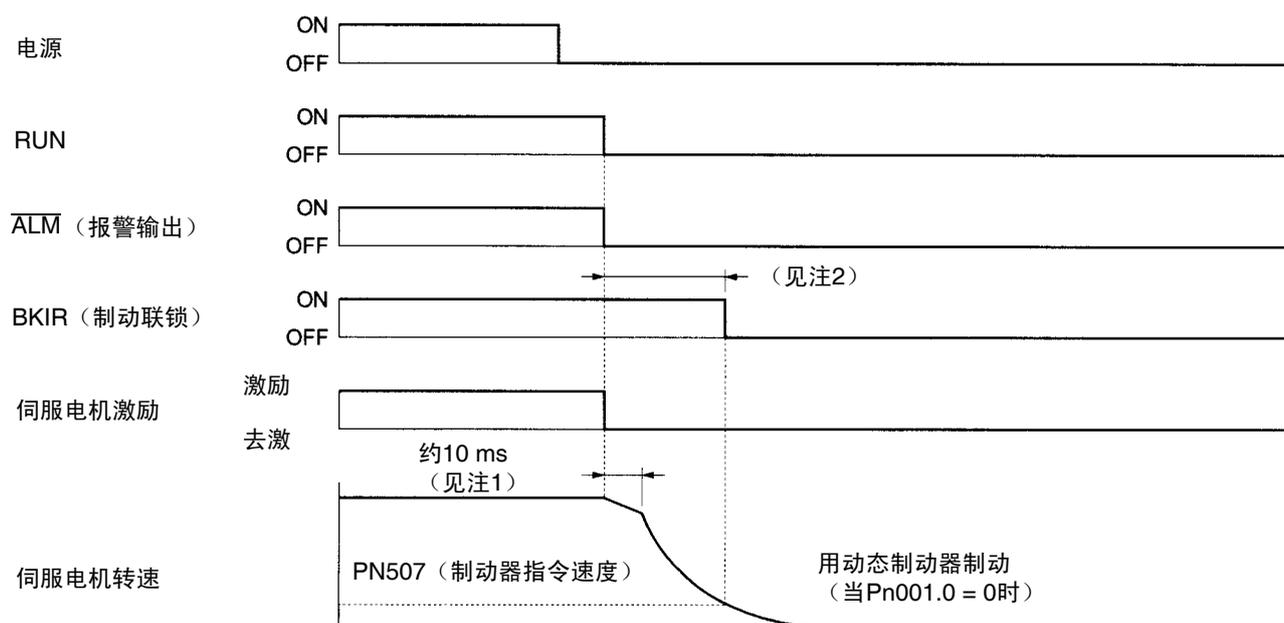
注 1. 从伺服电机去激励到施加动态制动器约需要10 ms，在此期间，由于动量的作用，伺服电机将继续旋转。
