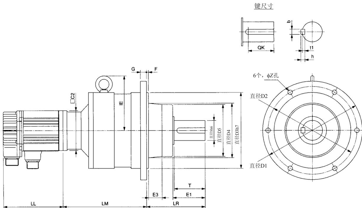
● 带标准齿轮的1,500-r/min伺服电机 (450 W~4.4 kW)
