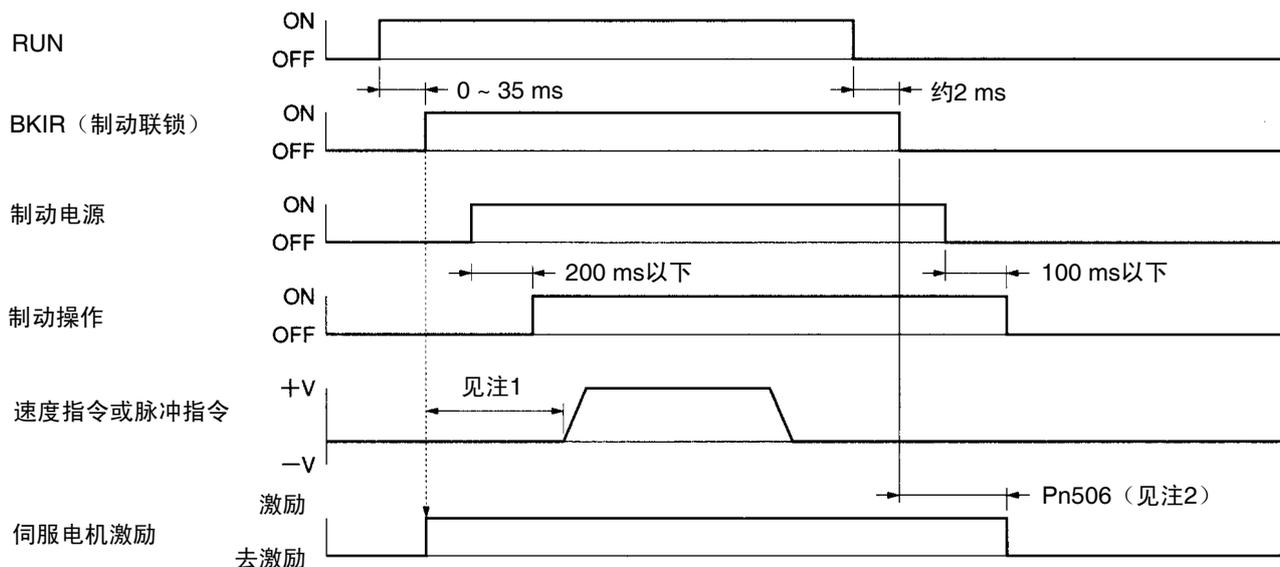
注 1. 从接通制动器电源到释放制动器的时间最长为200 ms。设置制动器释放后发送速度指令 (脉冲指令) 时将该延迟考虑在内。
