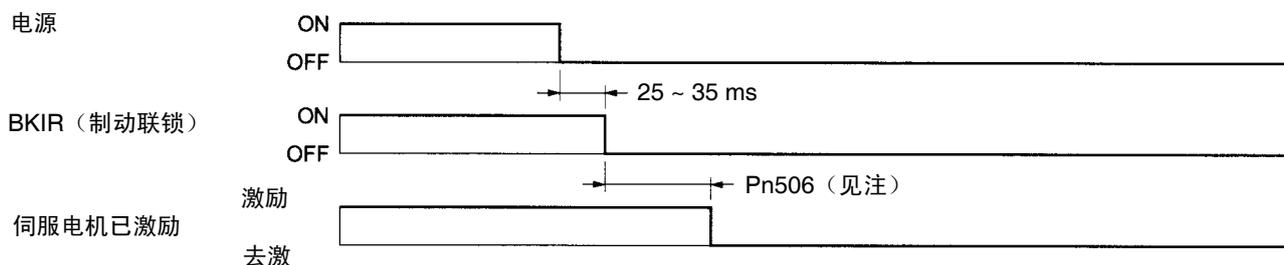
注 从断开制动器电源到制动器啮合之间的最长时间为100 ms。如果在纵轴上使用伺服电机，则设置 Pn506（制动时间1），使伺服电机在制动器啮合后去激励，同时将该延迟考虑在内。
