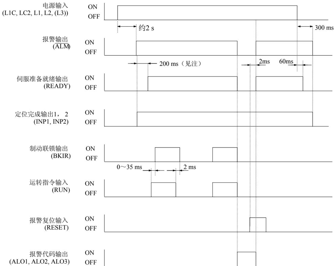
注 使用绝对值编码器时，在输入SEN信号约250 ms后，此信号仍保持接通。
