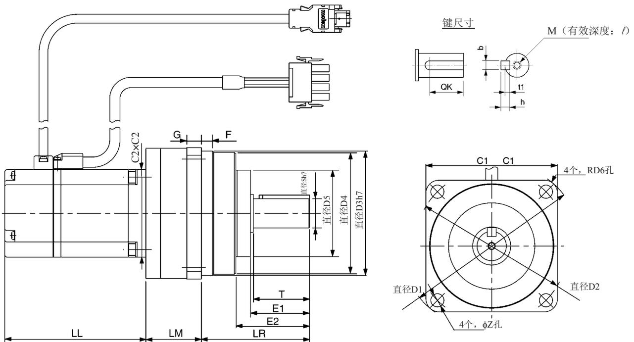
● 带标准齿轮的3,000-r/min伺服电机 (1 ~ 5 kW)
