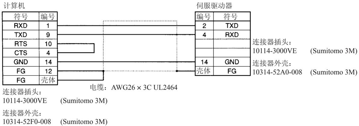
■ 控制输入 / 输出连接器 (R88A-CNU11C)
