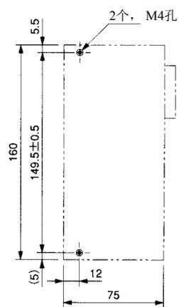
● 前面板安装 (使用安装托架)
