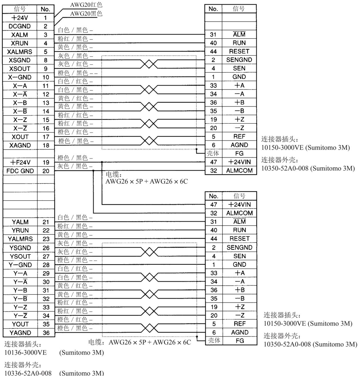
注 1. 控制器的符号是DRVX-Y连接器的符号。在DRVZ-U连接器中，X → Z，Y → U。
