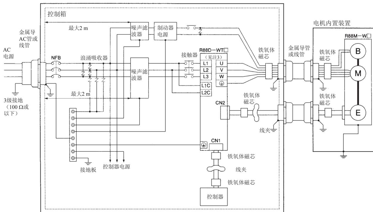
注 1. 将铁氧体磁芯的电缆绕组作1.5匝。
