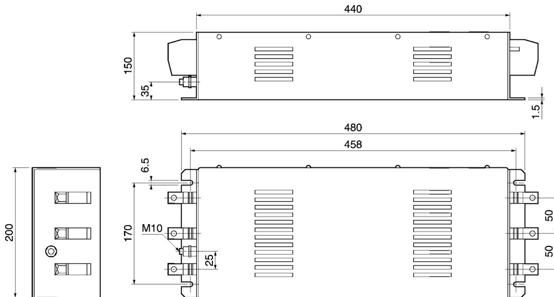
● 用于制动器电源的噪声滤波器
