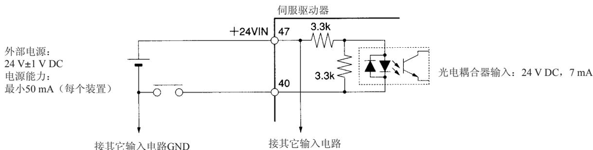
信号电平 接通电平：最小值 (+24VIN-11) V
