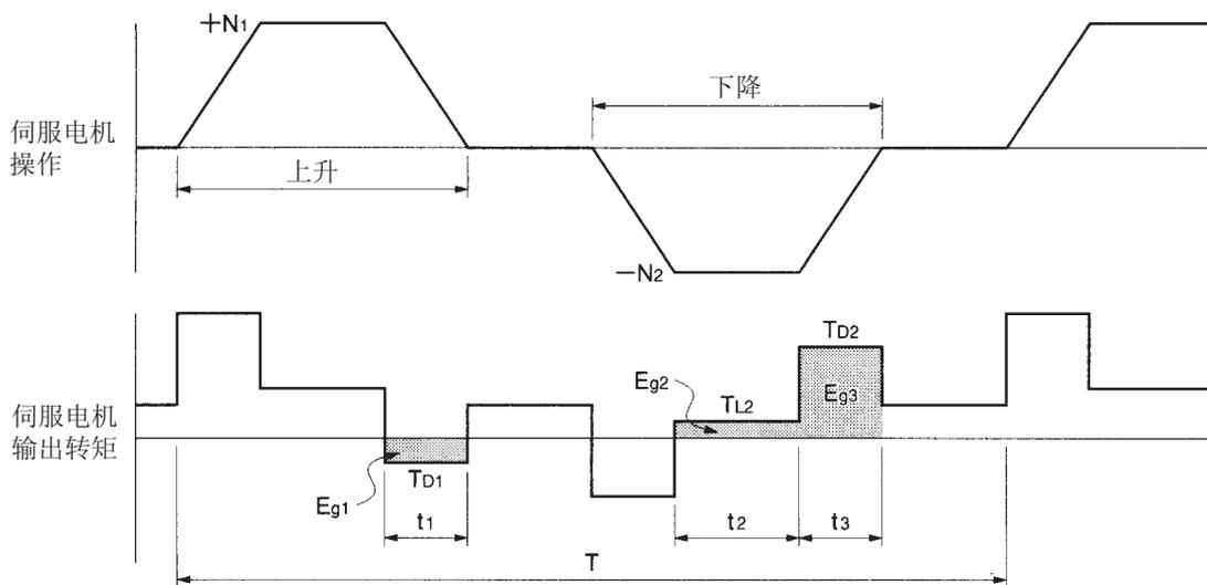
注 在输出转矩图中，正向（上升）上的加速为正，反向（下降）的加速为负。
