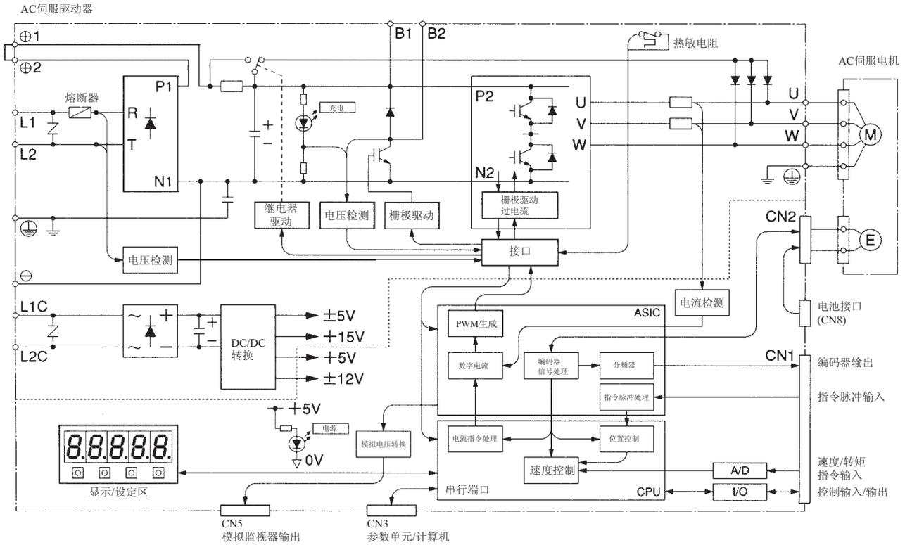
■ 200 V AC: R88D-WT05H/-WT08H/-WT10H/-WT15H
