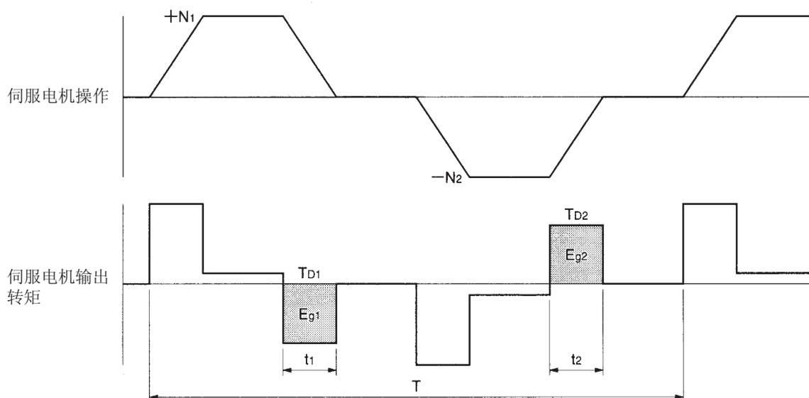
注 在输出转矩图中，正向上的加速为正值，反向上的加速为负值。
