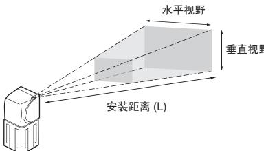
光学检测卡上会显示水平视野。 垂直视野约为水平视野的 60%。
