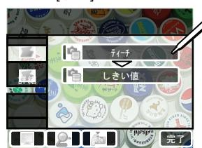
输入对象的图像，作为检测参考。移动矩形框，使“位置补偿”的特性部分位于矩形框之内。
