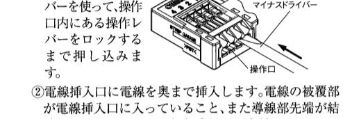
②電線挿入口に電線を奥まで挿入します。電線の被覆部が電線挿入口に入っていること、また導線部先端が結線部を通していることを確認してください。
