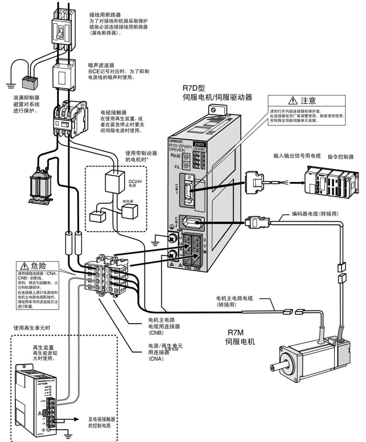
\* : 制动器用DC24V电源和顺控器用电源请不要混同使用。
