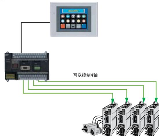
具有2轴1MHz脉冲输出, 可以完成高精度的定位控制。以标准装备就能实现4轴伺服控制。PLC:CP1H无需追加单元+不需要调节的伺服Smartstep Z series→实现应用
