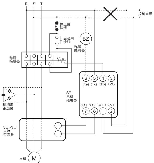
注：电机继电器用控制电源，请与电机供给用电源分开。请将反相要素“OFF”后使用。
