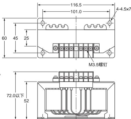
※SE-PT400可以用于控制电源电压AC200/220/240V的全部SE。
