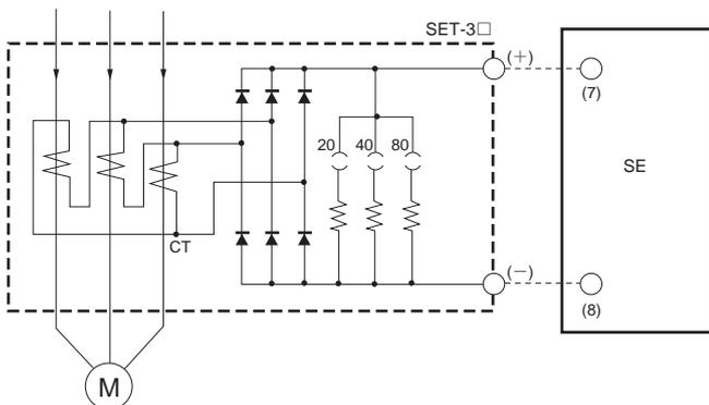
在上图中，电机电流被SET-3□的CT三相全波整流，用各螺孔的电阻器转换成适合SE的直流电压后，从+和-端子输出。该电压在三相齐全时和欠相或不平衡时含有的直流和交流部分是不同的。
