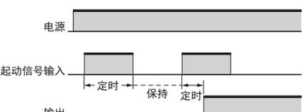
信号定时许可功能 (信号断开时、断电时定时停止)。
