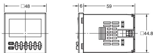
注: 端子螺钉为M3.5。(有效螺钉深度6mm)
