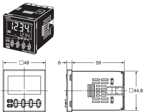
注: 端子螺钉为M3.5。(有效螺钉深度6mm)
