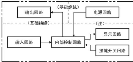
注：电源与输入回路为基础绝缘。（但H5CX-□D-N为非绝缘。）
