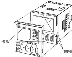
前面板通过位于4个部位的卡爪固定到本体。拆卸面板时，将4个卡爪拧下。
