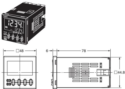
注: 端子螺钉为M3.5。(有效螺钉深度6mm)
