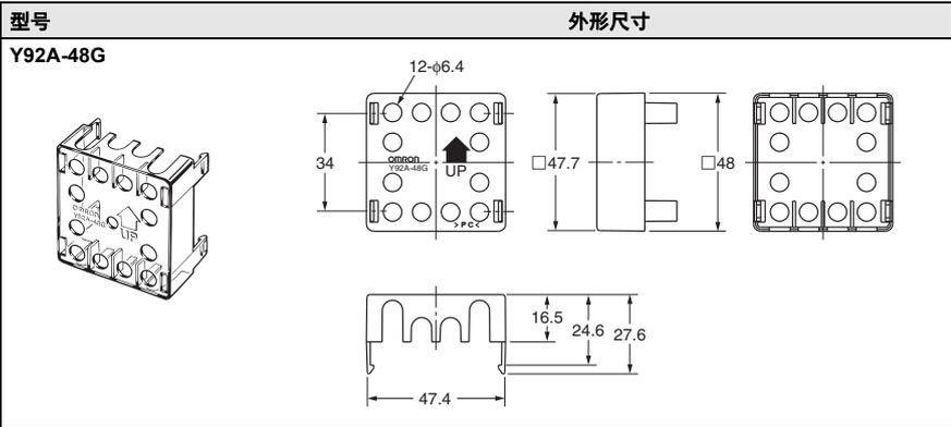
注：通过在背面连接插座（P3G-08/P3GA-11）的安装、使用，实现指触保护。
