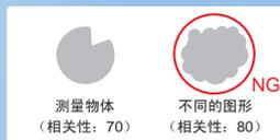
形状不完美，产生较低相关性。不正确检测测量区域内部相同尺寸和颜色的污垢。
