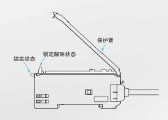
**注**1. 为保护光纤的性能,请确定锁定状态已经解除后再拔出光纤。 **2.** 光纤的锁定、解除请在一10℃~40℃温度环境中进行。
