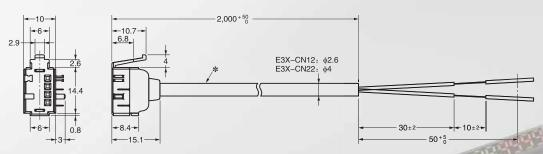
\* E3X-CN12: 乙烯绝缘体圆形导线 $\phi$ 4、1芯(导体截面积:  $0.2mm^2$ 、绝缘体直径:  $\phi$ 1.1mm)
