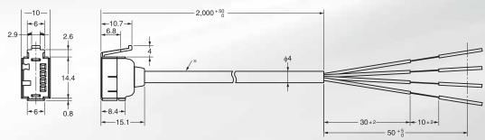
\* E3X-CN11:乙烯绝缘体圆形导线 $\phi$ 4、3芯(导体截面积:0.2mm²、绝缘体直径: $\phi$ 1.1mm)
