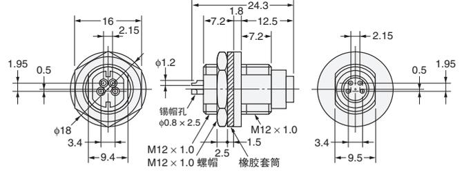
XS3P螺钉接线型和卡入型安装尺寸
