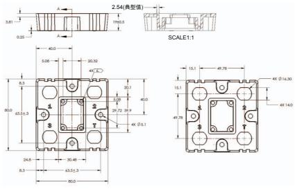
QX-1光电传感器, M12 4针插头, NPN - 2米 - 入光时ON/遮光时ON 99-9000016-01
