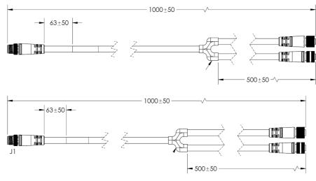
M12 至跨线电缆,直线型电源, IO, RS-232, USB-3米或5米
