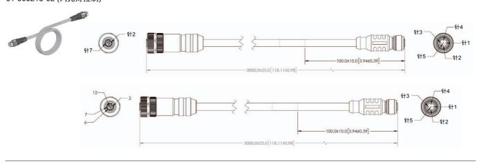
Y型电缆,相机/电源和智能照明电源(持续开启)-1米 61-9000135-01
