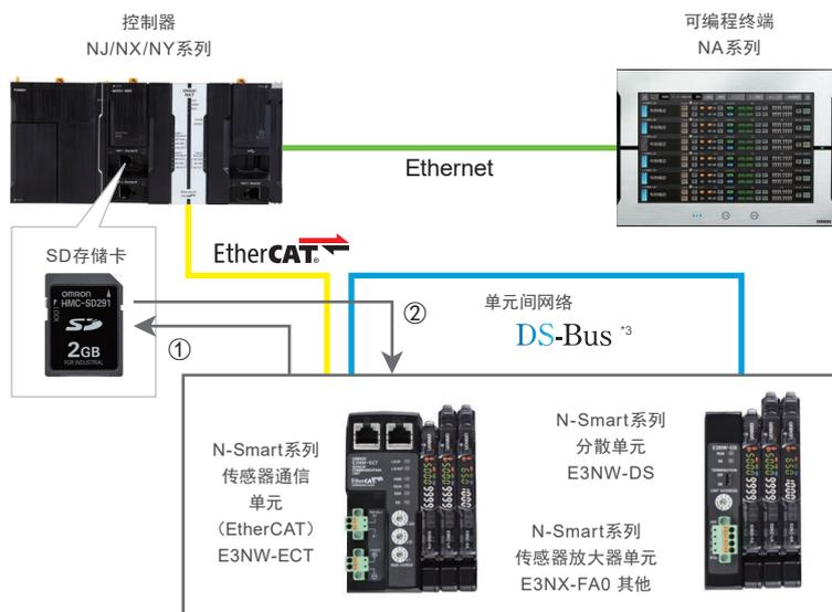
也可对各节点、各放大器的多种参数进行备份,从而通过在显示器中指定应恢复的参数种类,有效进行多个品种的换产。
