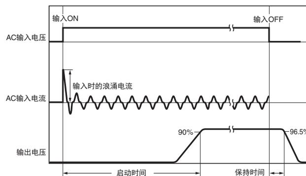
注：两倍或以上的输入电流将在冗余系统的过程中流入。因此，请确认保险丝的熔断特性以及断路器的操作特性，从而确保外部保险丝不会熔断并且断路器不会因浪涌电流而动作。
