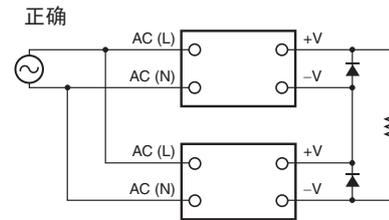
注1. 二极管如图中所示连接。如果负载短路，电源内部会产生反向电压。如果发生这种情况，可能导致电源老化或损坏。请务必按照图示连接二极管。请按照以下额定规格选择二极管。
