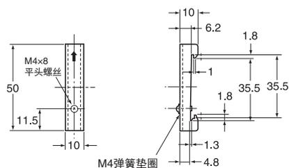
注：如果单元可能受到振动或冲击，请使用钢质DIN导轨。否则金属可能因磨损导致铝制产品产生破损。
