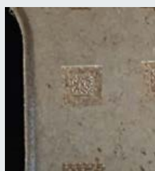
铁齿轮，经底层处理 单元大小： 0.127mm
