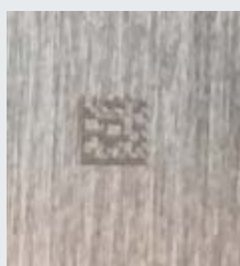
铁齿轮，经底层处理 单元大小： 0.127mm
