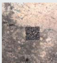
铝铸件，未经底层处理 单元大小： 0.127mm
