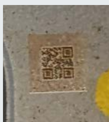
铁齿轮，经底层处理 单元大小： 0.127mm
