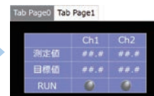
在系统变量“_HMI_CurrentPageIndex”中输入相当于页面号的数值后， 变更为指定编号。
