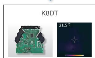
市售的测量和监测继电器采用电容器分压电路方式，因此会受高频干扰（变频干扰）的影响而发热，导致产品寿命变短。
