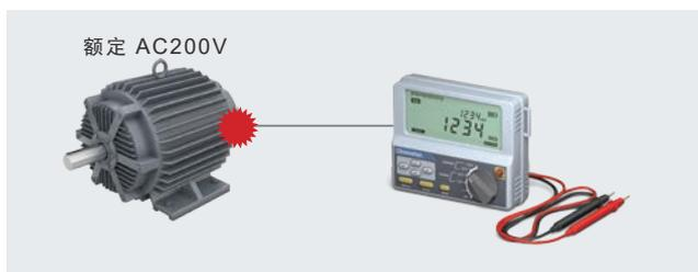
必须根据测量对象的额定值选择电压范围
