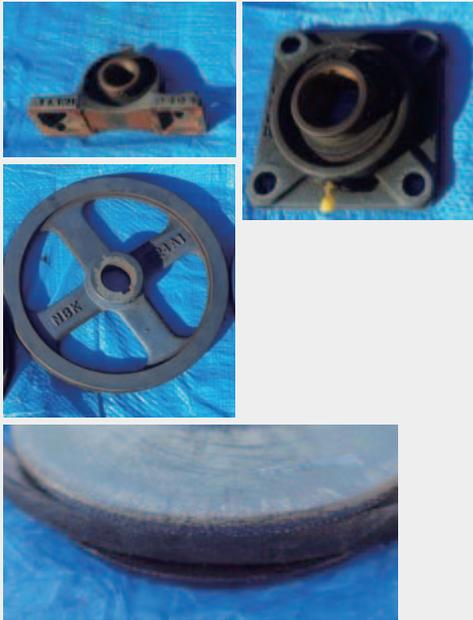
皮带和皮带轮因摩擦而磨损
