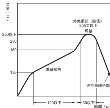
（温度Profile是表示印刷基板面的温度）
