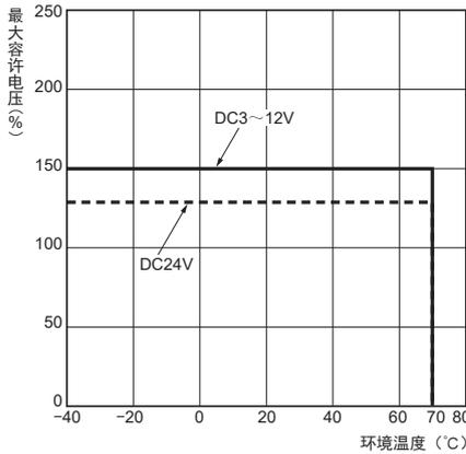
注: 最大允许电压指的是继电器线圈电压容许变动范围的最大值。
