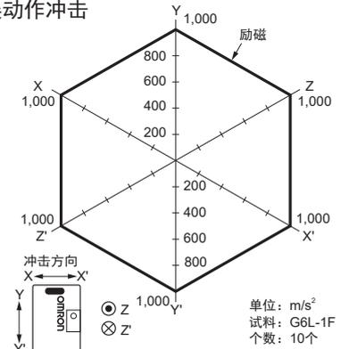
测定: 无励磁、励磁状态下, 往3轴6个方向各加3次冲击, 测定接点产生误动作的值。
