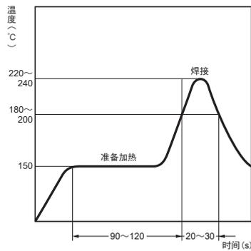
（温度Profile是表示印刷基板面的温度）
