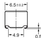
印刷基板加工尺寸 (TOP VIEW)
