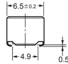
印刷基板加工尺寸 (TOP VIEW)
