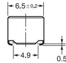
印刷基板加工尺寸 (TOP VIEW)
