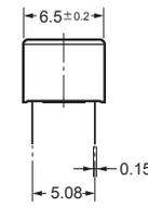
印刷基板加工尺寸 (BOTTOM VIEW)
