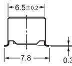
印刷基板加工尺寸 (TOP VIEW)
