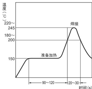
（温度Profile是表示印刷基板面的温度）
