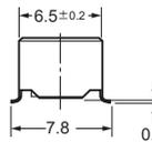
印刷基板加工尺寸 (TOP VIEW)
