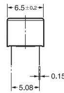
印刷基板加工尺寸 (BOTTOM VIEW)
