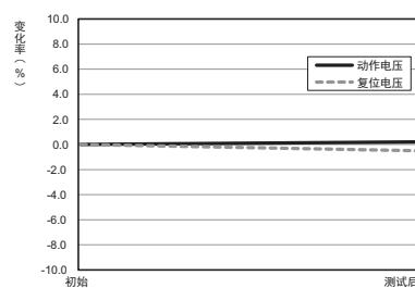
对样例(无励磁)施加频率 33Hz 45m/s<sup>2</sup> 的振动, 经过上下方向约 4 小时, 前后各 2 小时后测得各项特性。变化百分比率(%)为样例的平均值。
