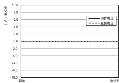
特性是在各给测试片的3轴6向施加3次490 m/s<sup>2</sup> 的振动条件下测得的。
