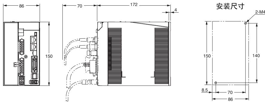
三相AC200V用 R88D-KN20H-ECT-Z(2kW)
