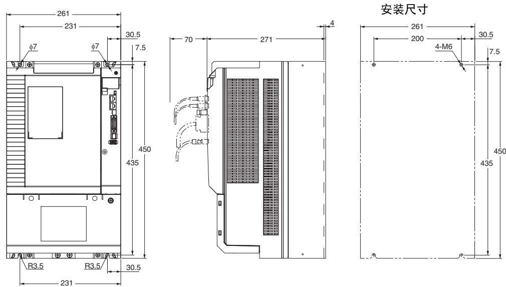
三相AC400V用 R88D-KN06F-ECT-Z/-KN10F-ECT-Z(600W~1.0kW)
