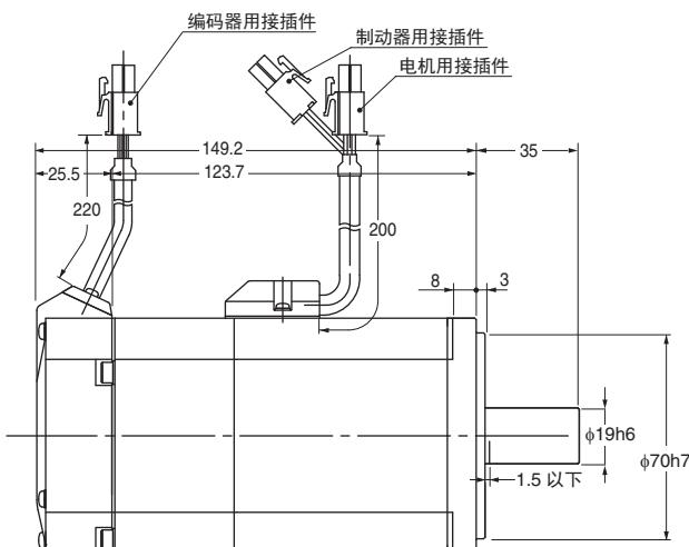
(带键、螺纹轴端规格)
