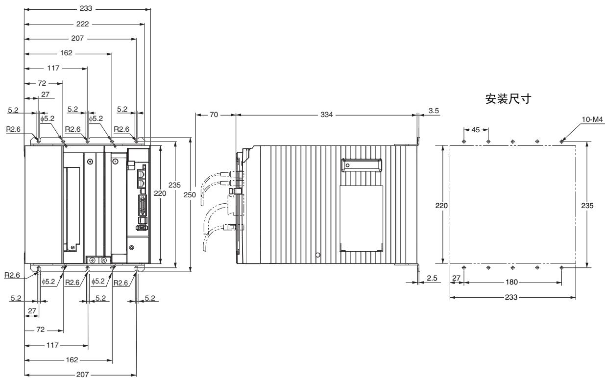
三相AC400V用 R88D-KN150F-ECT-Z(15kW)
