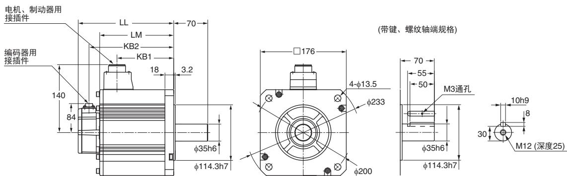
注：标准的轴形状为直轴。型号后面有“S2”时带键、螺纹孔。
