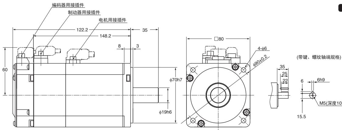
注：标准的轴形状为直轴。型号后面有“S2”时带键、螺纹孔。
