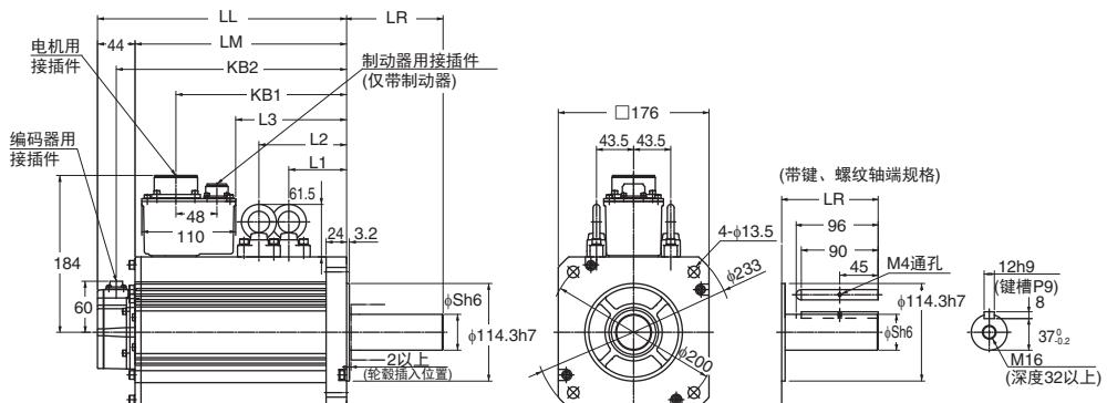
注：标准的轴形状为直轴。型号后面有“S2”时带键、螺纹孔。
