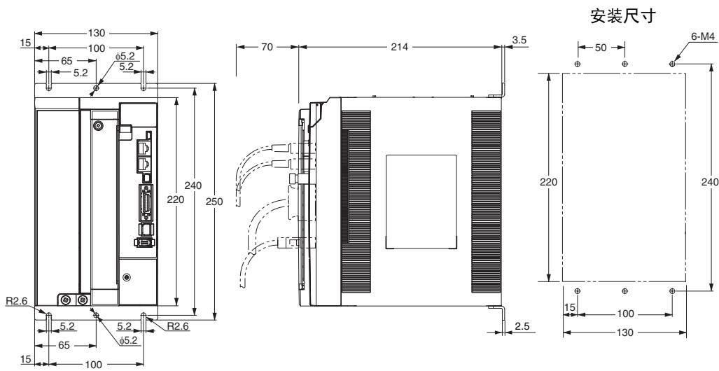
三相AC400V用 R88D-KN75F-ECT-Z(7.5kW)
