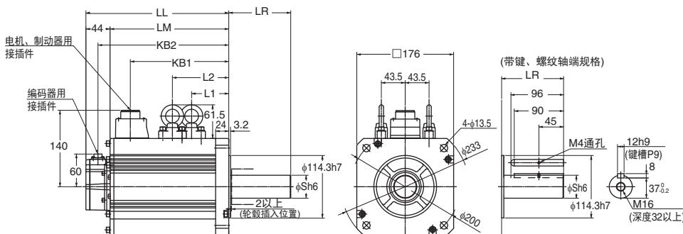
注：标准的轴形状为直轴。型号后面有“S2”时带键、螺纹孔。
