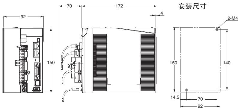
三相AC400V用 R88D-KN20F-ECT-Z(2kW)
