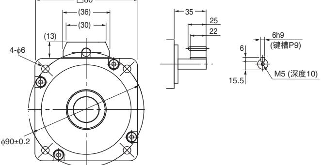
注：标准的轴形状为直轴。型号后面有“S2”时带键、螺纹孔。
