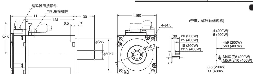
注：标准的轴形状为直轴。型号后面有“S2”时带键、螺纹孔。
