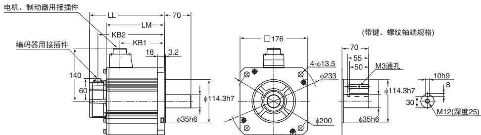
注：标准的轴形状为直轴。型号后面有“S2”时带键、螺纹孔。
