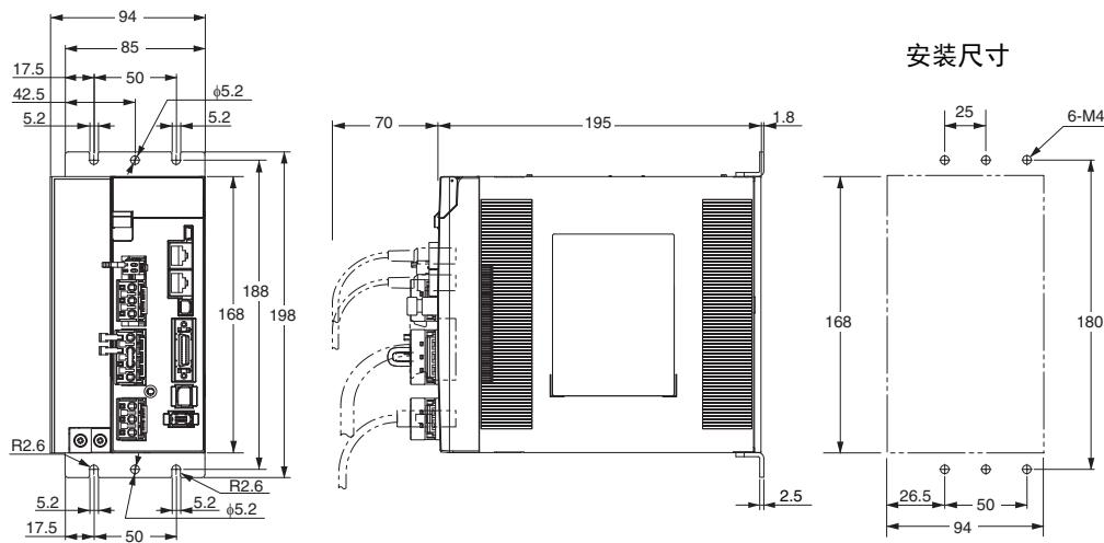
三相AC400V用 R88D-KN30F-ECT-Z/-KN50F-ECT-Z(3~5kW)
