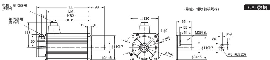
注：标准的轴形状为直轴。型号后面有“S2”时带键、螺纹孔。
