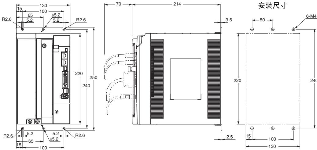
三相AC200V用 R88D-KN75H-ECT-Z(7.5kW)
