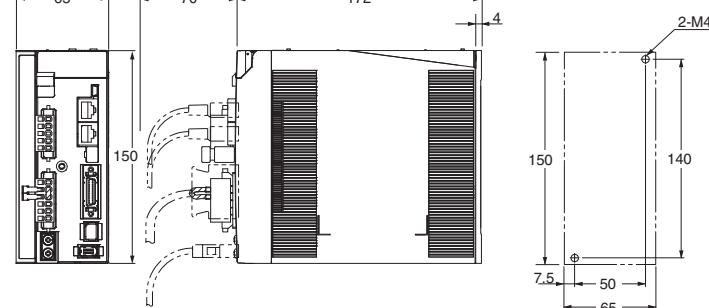
单相/三相AC200V用 R88D-KN10H-ECT-Z/-KN15H-ECT-Z(900W~1.5kW)
