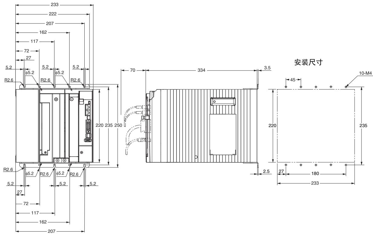
三相AC200V用 R88D-KN150H-ECT-Z(15kW)
