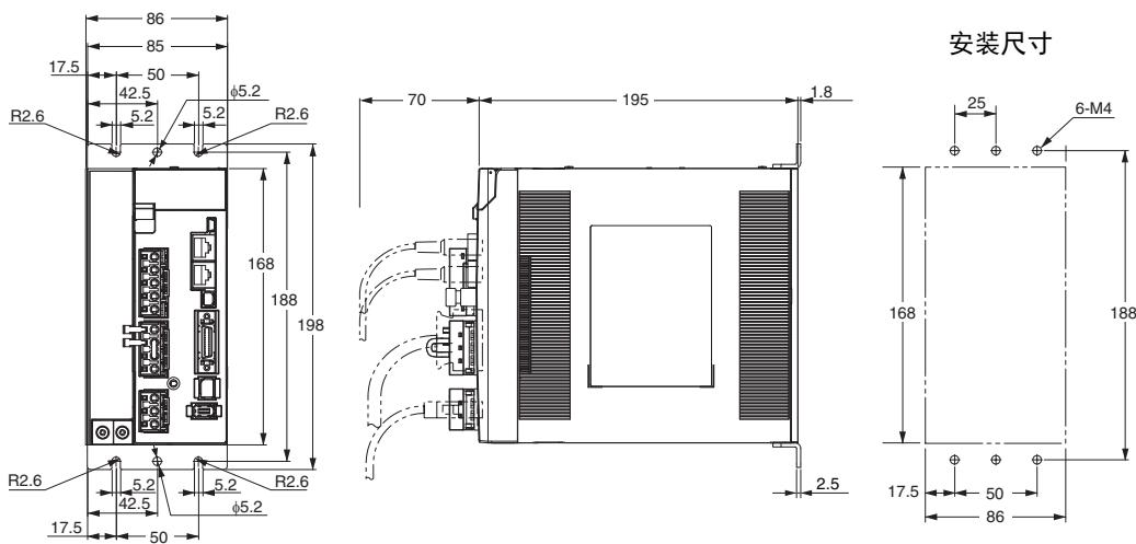
三相AC200V用 R88D-KN30H-ECT-Z/-KN50H-ECT-Z(3~5kW)
